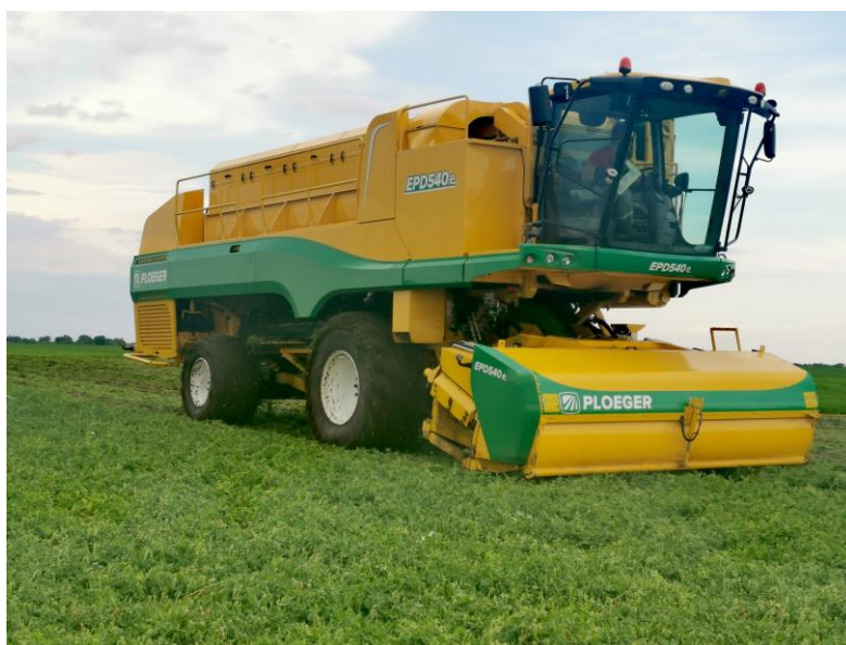
Slika 21. Kombajn za grašak (izvor: Stipo Vujica)
