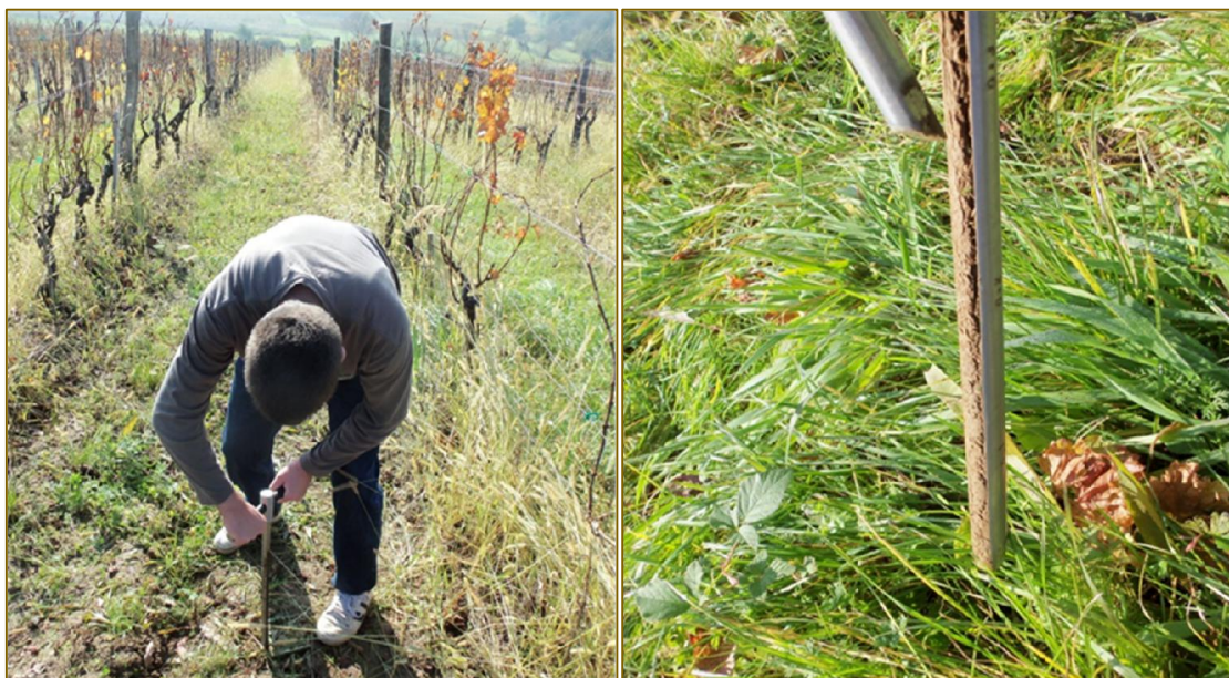
Slika 5. Uzorkovanje tla agrokemijskom sondom (orig.)
