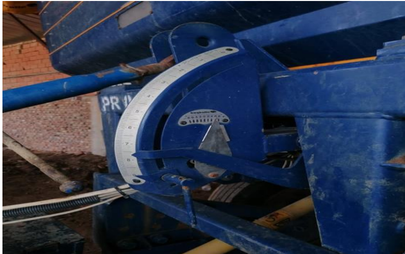
Slika 12. Namještanje kuta zakošenja rasipača
