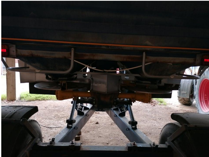
Slika 11. Diskovi na Bogballe rasipaču
