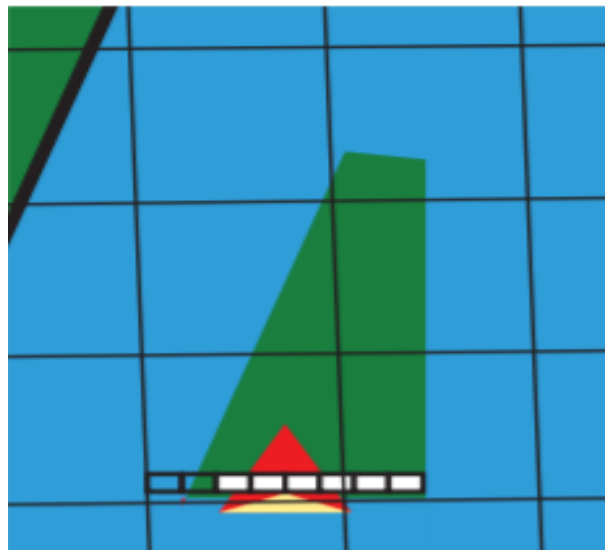
Slika 14. SC Standard Inteligentno raspodjeljivanje na nepravilnim rubovima
