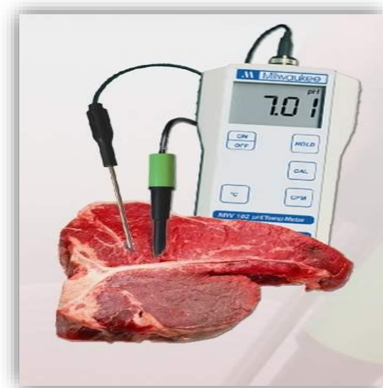
Slika 6. Mjerna sonda za mjerenje pH vrijednosti mesa
