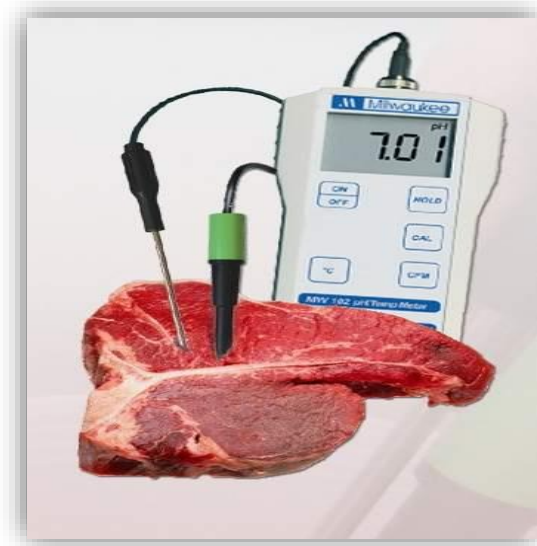
Slika 6. Mjerna sonda za mjerenje pH vrijednosti mesa
