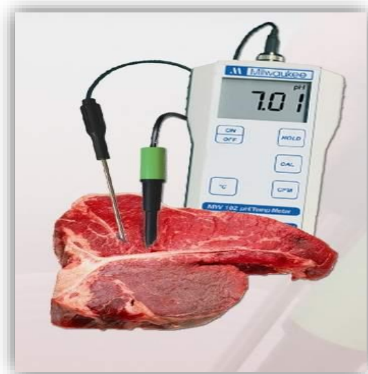
Slika 6. Mjerna sonda za mjerenje pH vrijednosti mesa
