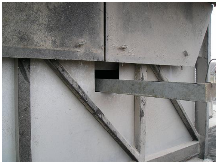
Slika 18. Lijevak za izuzimanje osušenoga ječma (vlastita fotografija)
