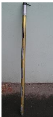
Slika 9. Izuzimač uzorka (vlastita fotografija)
