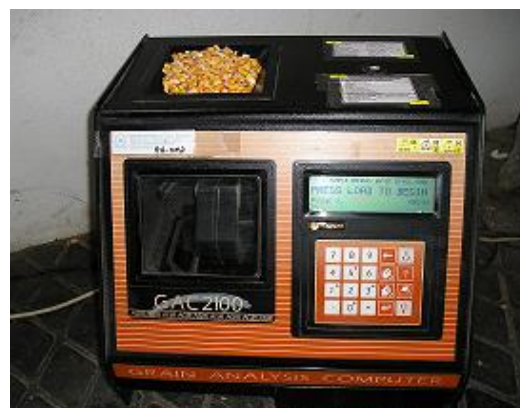
Slika 10. Električni vlagomjer (vlastita fotografija)
