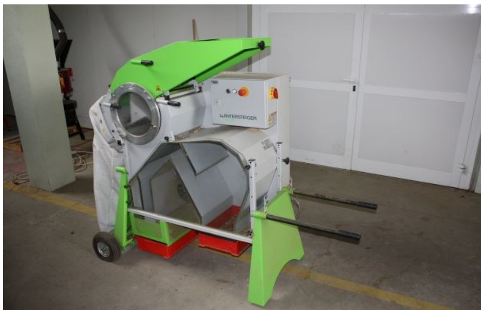
Slika 2. Vršalica Wintersteiger LD 350 – (foto original; I. Varnica)
