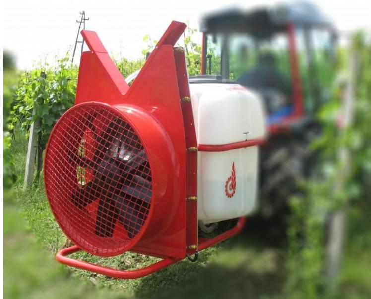
Slika 7. Nošeni raspršivač Agromehanika
