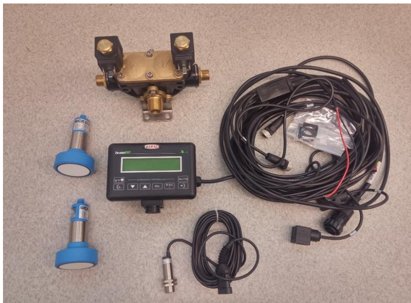
Slika 6. Sustav ultrazvučnih senzora
