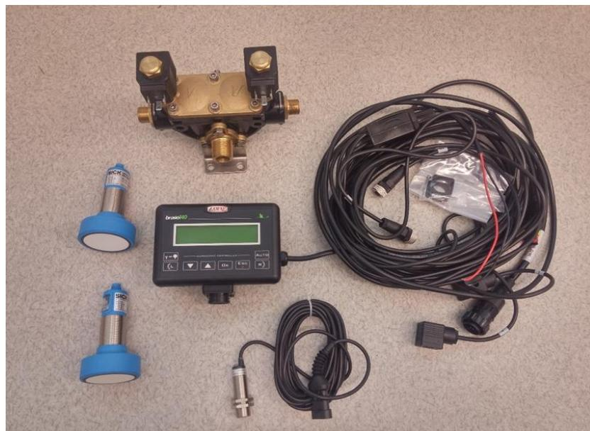
Slika 6. Sustav ultrazvučnih senzora
