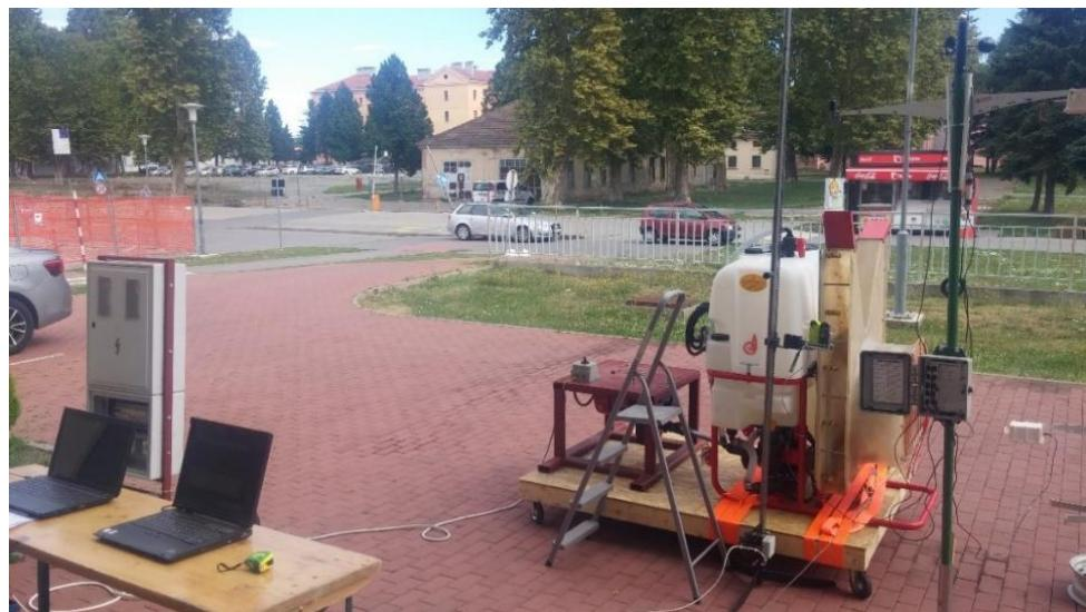
Slika 11. Mjerenje vertikalne raspodjele zraka anemometrom Kestrel 4500 BT
