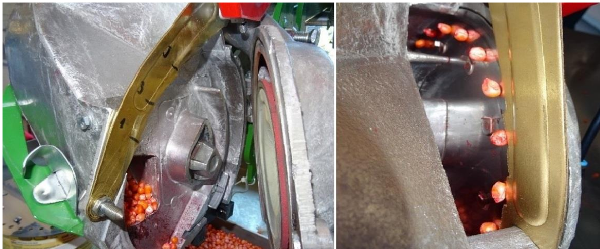
Slika 9. Komora za sjeme (lijevo) i skidač viška sjemena (desno)
