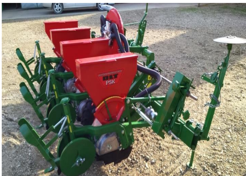
Slika 6. Pneumatska sijačica PSK4
