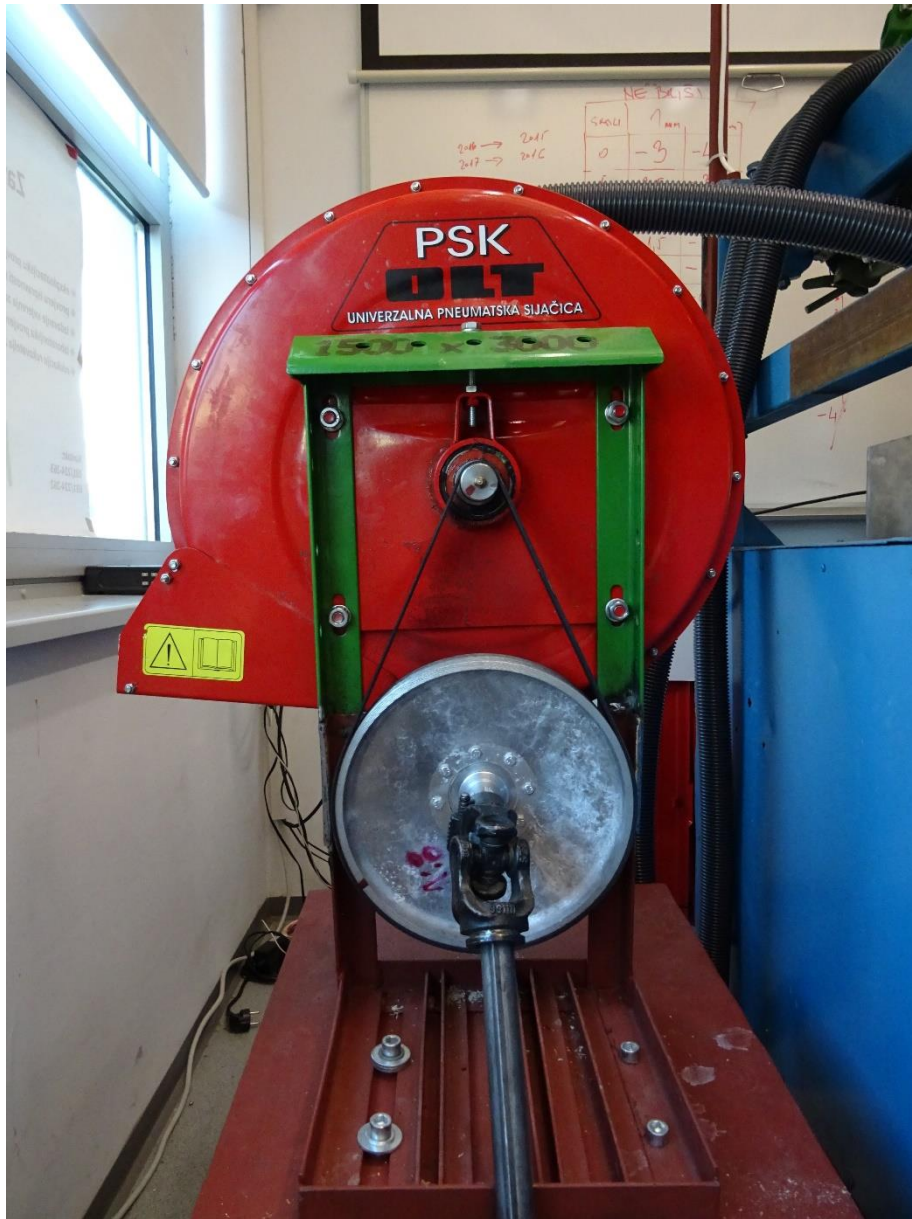
Slika 13. Radijalni ventilator sijačice PSK4
