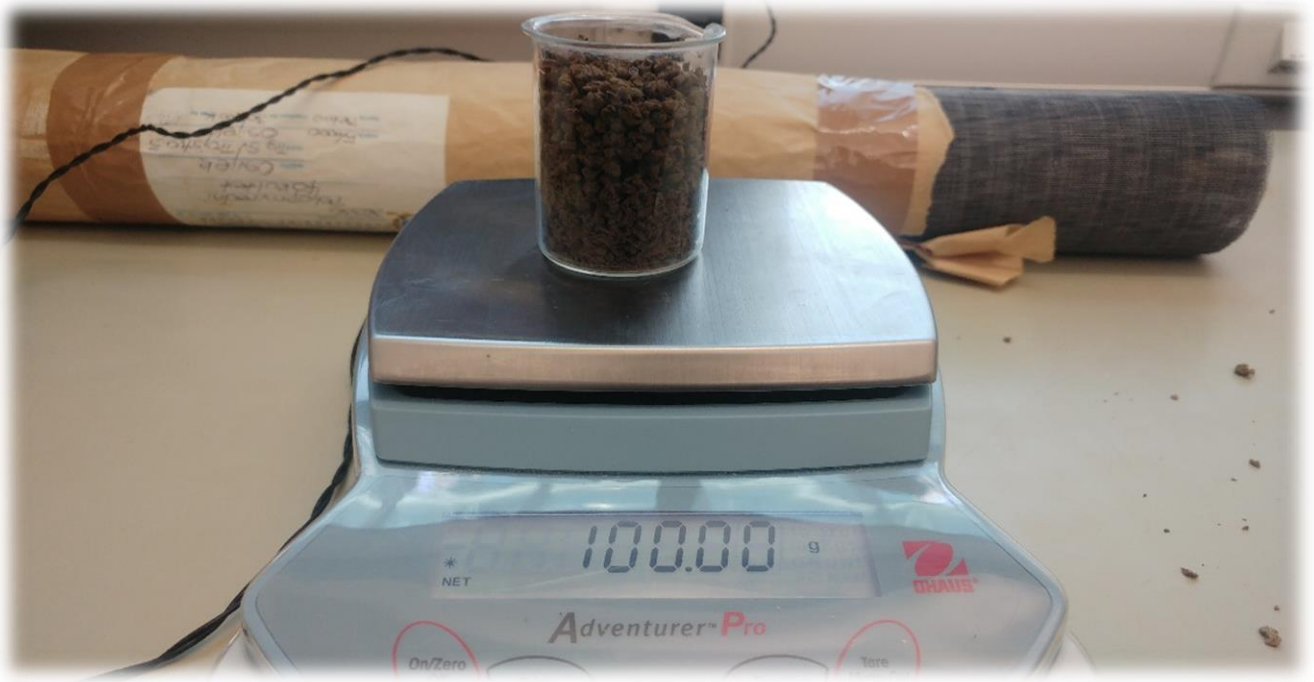
Slika 10. Odvajanje 100 grama tla za izdvajanje nematoda (Izvor: David Alexander Župan)
