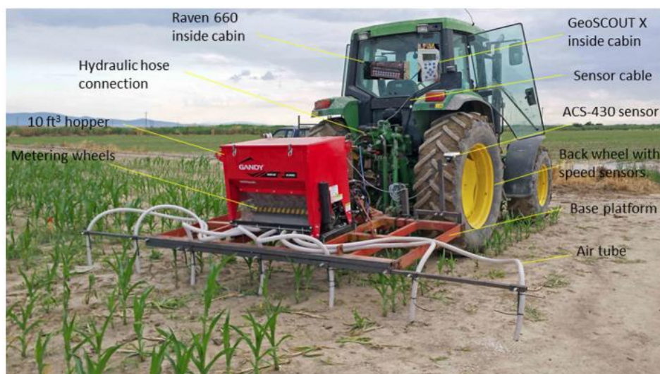
Slika 35. Prikaza komponenata varijabilnog sustava gnojidbe
