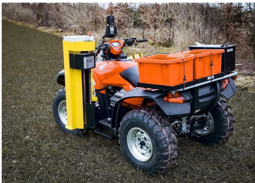
Slika 4. Vozilo opremljeno uređajem za uzimanje uzoraka
