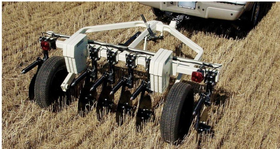
Slika 2. Vučeni uređaj za mjerjenje elektrovodljivosti tla
