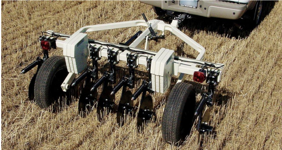
Slika 2. Vučeni uređaj za mjerenje elektrovodljivosti tla
