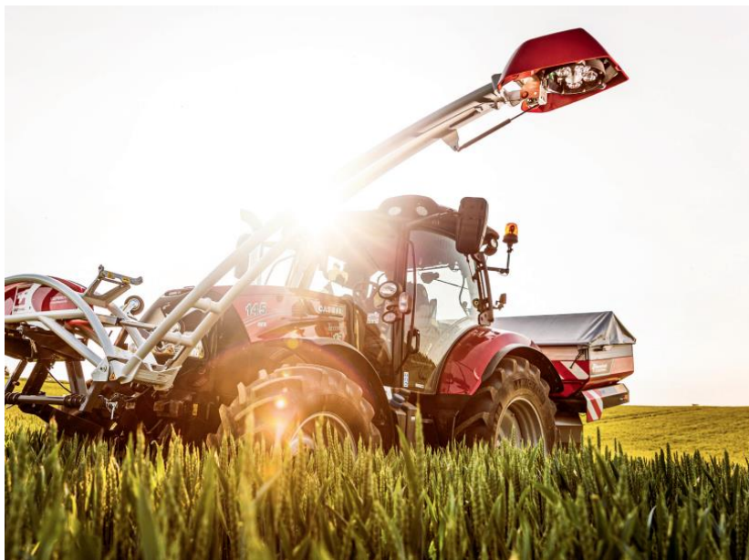
Slika 22. Senzor usjeva agregatiran s traktorom u prihrani
