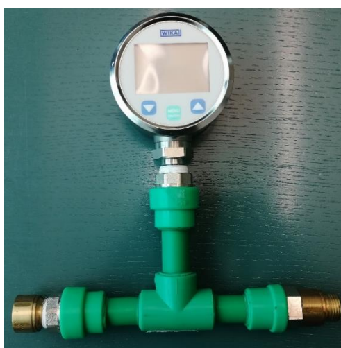
Slika 14. Kontrolni digitalni manometar s nosačem mlaznice
