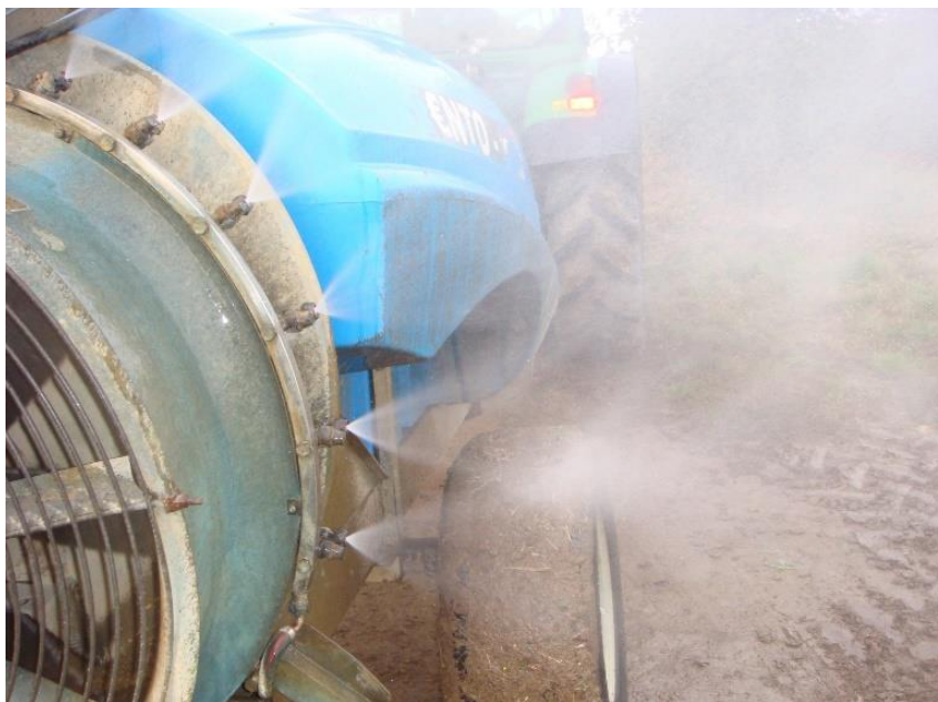
Slika 8. Postupak dezintegracije tekućine
