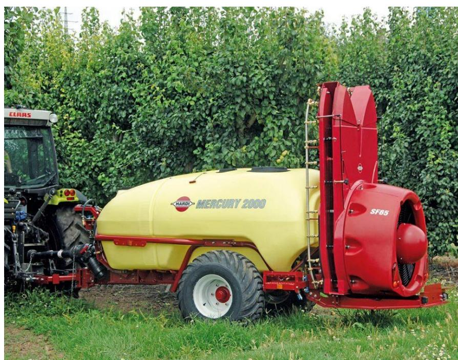
Slika 11. Vučeni traktorski raspršivač tvrtke Hardi
