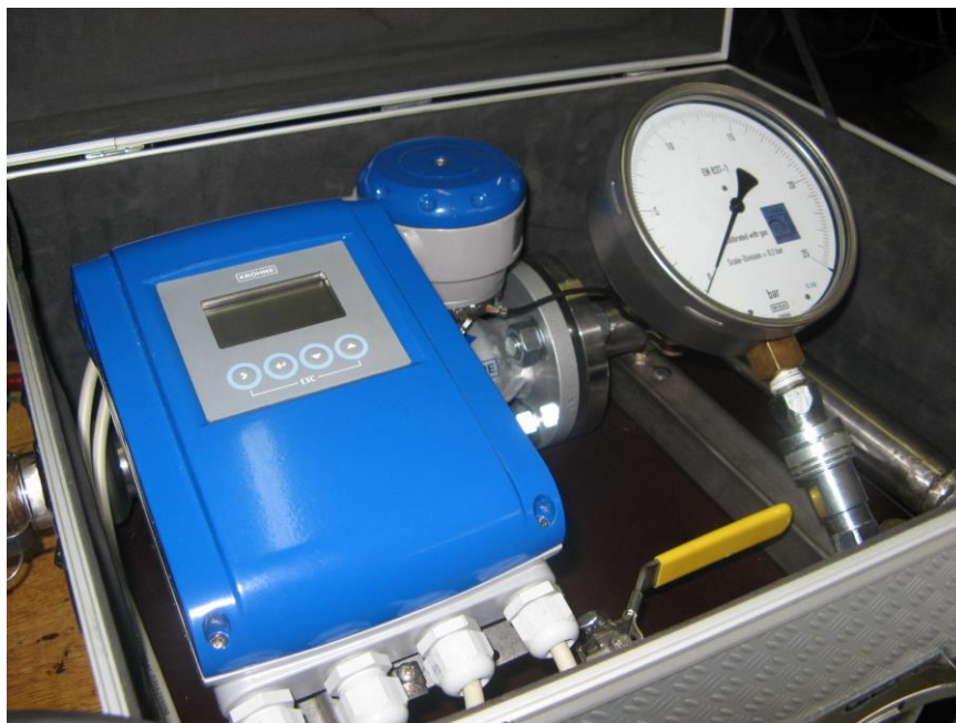
Slika 7. Mjerenje protoke crpke
