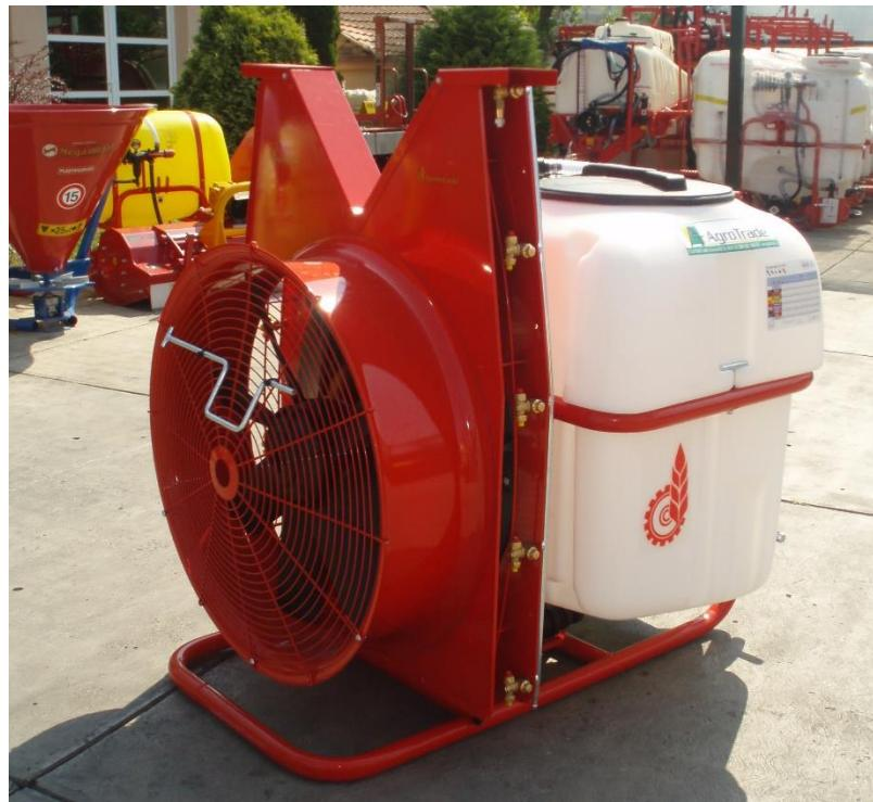
Slika 13. Nošeni raspršivač Agromehanika ENU 200
