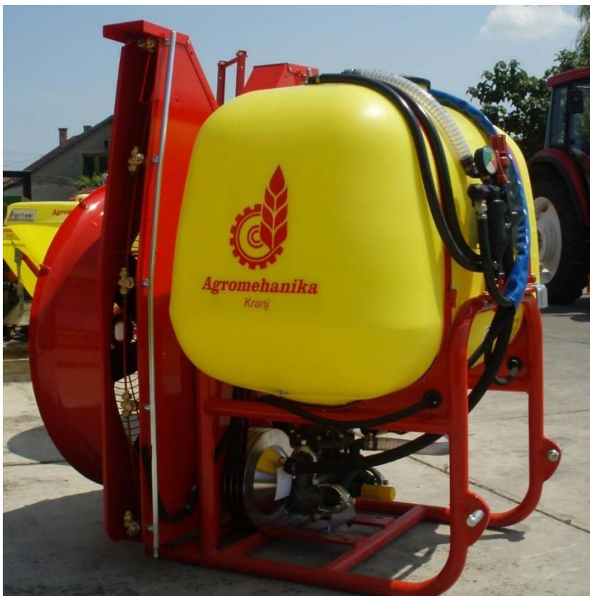
Slika 10. Traktorski nošeni raspršivač
