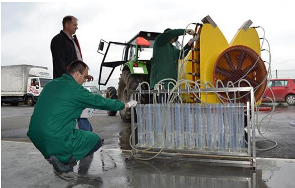
Slika 1. Redoviti pregled ispravnosti raspršivača (Izvor: Ivković I.)
