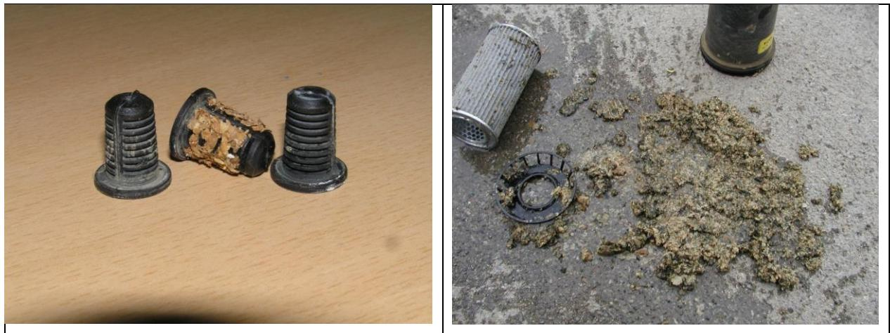
Slika 6. Nečistoće nakupljene u pročistaču
