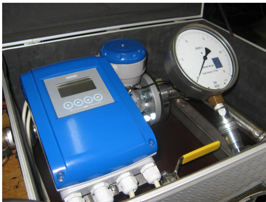
Slika 7. Mjerenje protoke crpke
