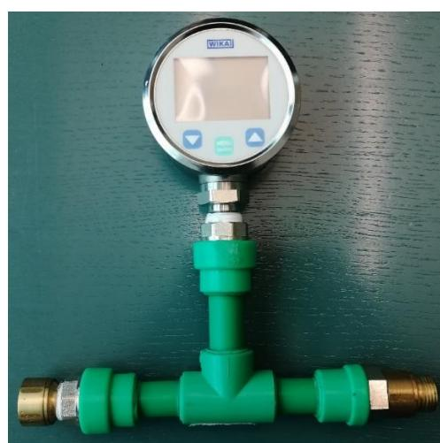
Slika 14. Kontrolni digitalni manometar s nosačem mlaznice
