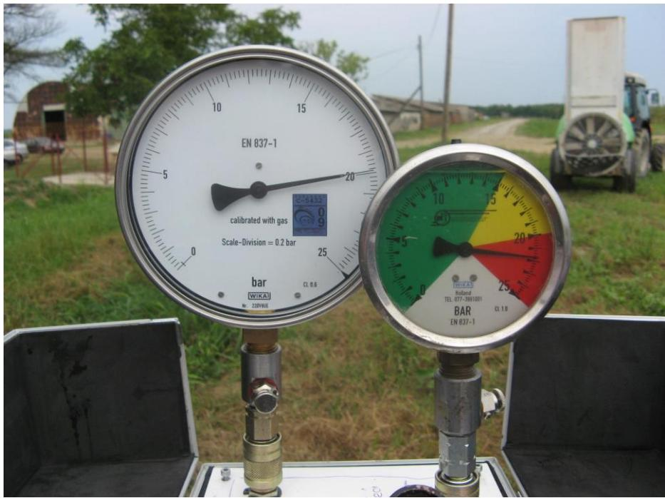
Slika 4. Uređaj za mjerjenje ispravnosti manometra Volos 2
