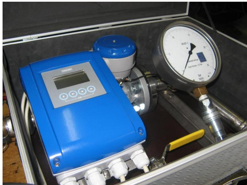
Slika 7. Mjerenje protoke crpke
