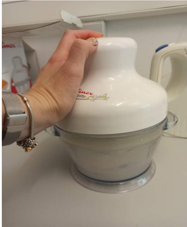
Slika 9. Misanje micelija gljive sa destiliranom vodom (original)
