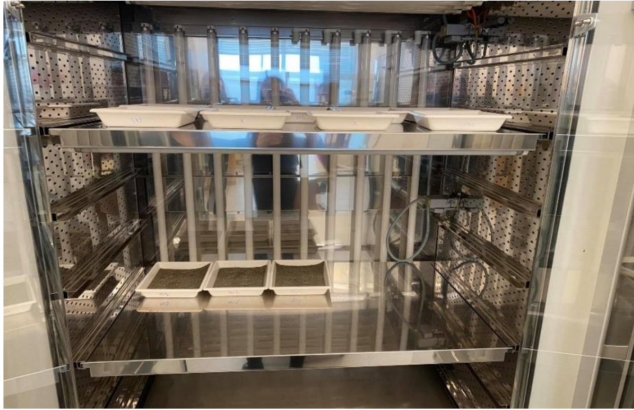
Slika 17. Komora za uzgoj biljaka
