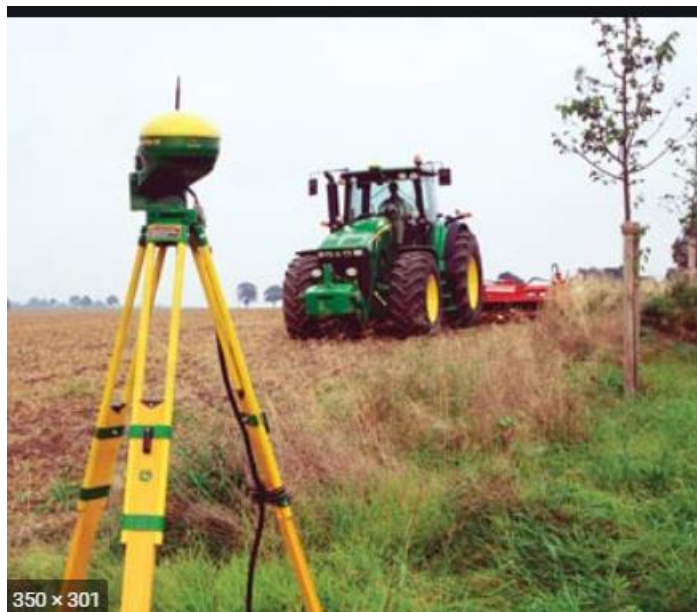
Slika 6. RTK bazna stanica
