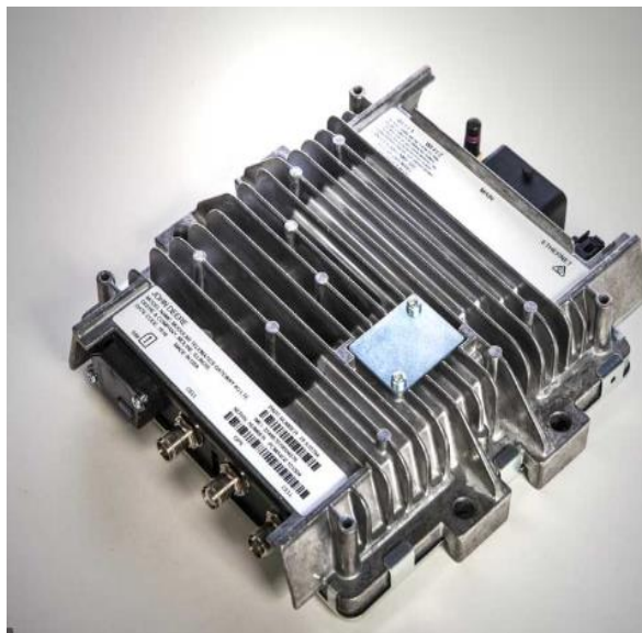
Slika 10. MTG 4LTE Telematski uređaj (Izvor: https://www.deere.com )
