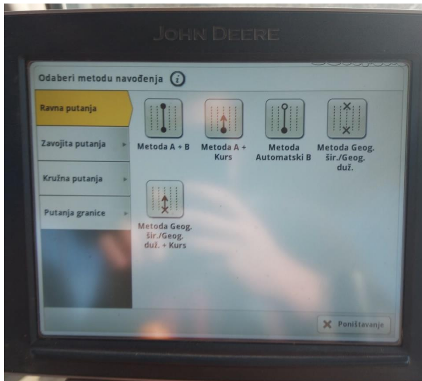
Slika 15. Metode navođenja za ravnu putanju (Izvor: vlastita fotografija)
