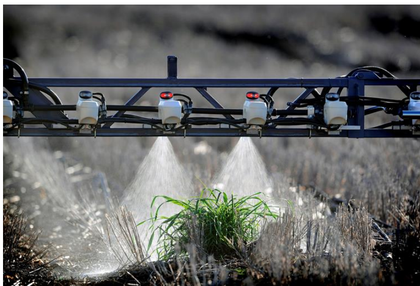
Slika 7. Prskalice opremljena sensorima korova (Izvor: https://www.weedmart.org.au )
