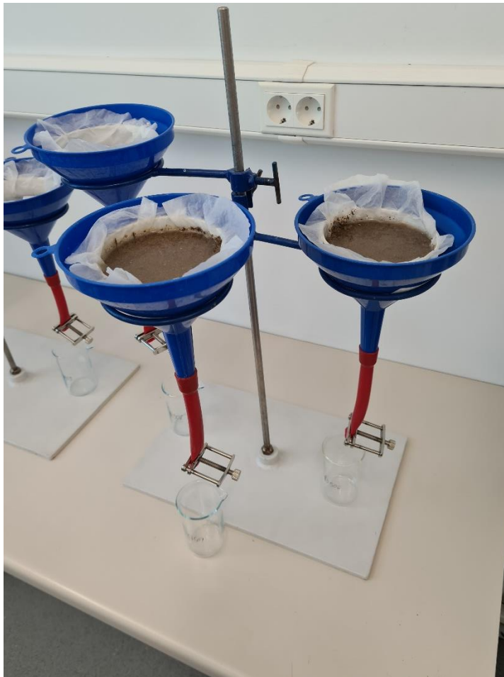
Slika 5. Izdvajanje nematoda Baermannovom metodom lijevka
