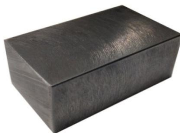
Slika 25. Ispitni uzorak čelika 42CrMo4 prije postupaka površinskog oplemenjivanja
