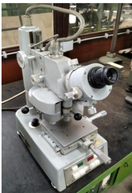
Slika 33. Mikroskop za ispitivanje tvrdoće po Vickersu tvrtke Shimadzu Corporation (Izvor: Šalov, 2021.)
