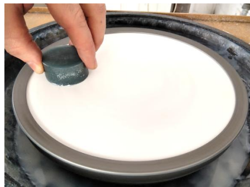
b) Poliranja uzoraka čelika 42CrMo4
