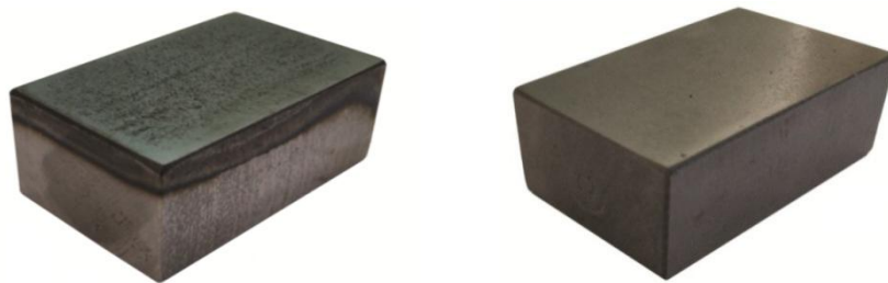
Slika 27. Uzorci čelika 42CrMo4 za ispitivanje trošenja nakon površinskog oplemenjivanja postupcima indukcijskog kaljenja i plinskog nitriranja (Izvor: Šalov, 2021.)
