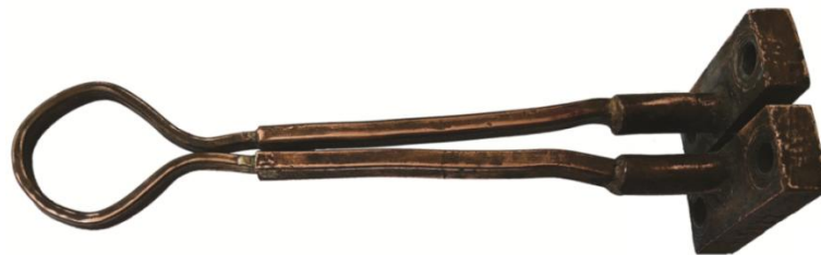
Slika 4. Jednovojni induktor (svitak)
