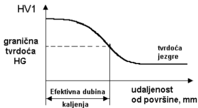
Slika 3. Određivanje efektivne dubine kaljenja (prema normi DIN 50190) (Izvor: Landek, 2012.)
