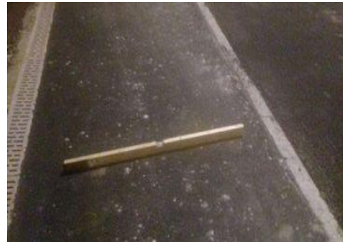
Slika 14) provjera kuta građevinskom labelom 600 mm na istoj stazi (Izvor: Autor, 2021.)
