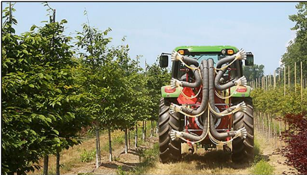
Slika 14. Raspršivač sa laserski sensorom za navođenje mlaza
