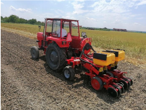
Slika 4. Sijačica MaterMacc Twin Row MS 8100 u sjetvi (lijevo) te razmak između redova u Twin Row tehnologiji (desno)
