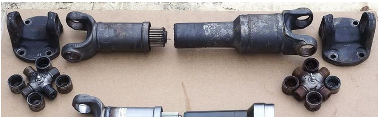
Slika 16. Primjena cementiranja na kardanskom vratilu traktora Fendt (Radić, 2021.)
