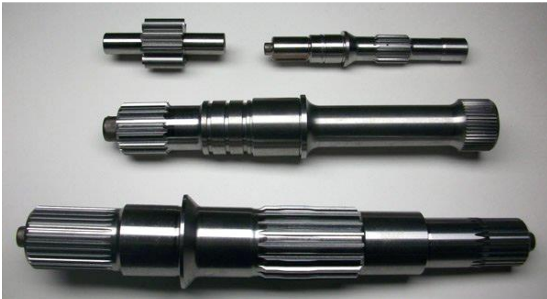
Slika 13. Primjena cementiranja na vratilima (Izvor: https://www.sst.net/service/casehardening/ )
