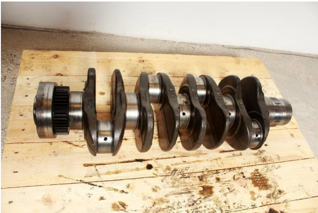
Slika 14. Koljenasto vratilo traktora Fendt (Fotografija: Šakota, 2021.)
