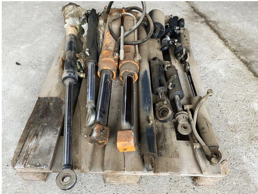
Slika 16. Hidraulički cilindri podiznih mehanizama različitih traktora (Fotografija: Šakota, 2021.)
