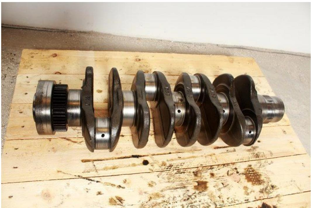
Slika 14. Koljenasto vratilo traktora Fendt (Fotografija: Šakota, 2021.)
