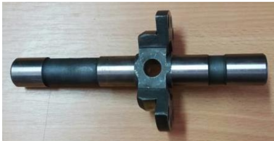
Slika 15. Vratilo diferencijala motokultivatora Goldoni (Fotografija: Šakota, 2021.)
