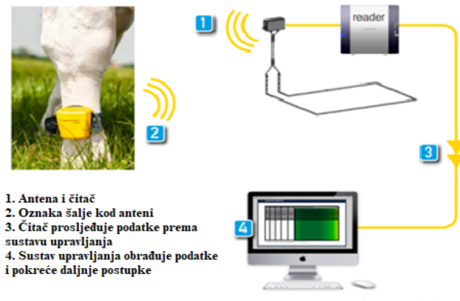
Slika 7. Način rada RFID tehnologija (Nedap, 2017.)
