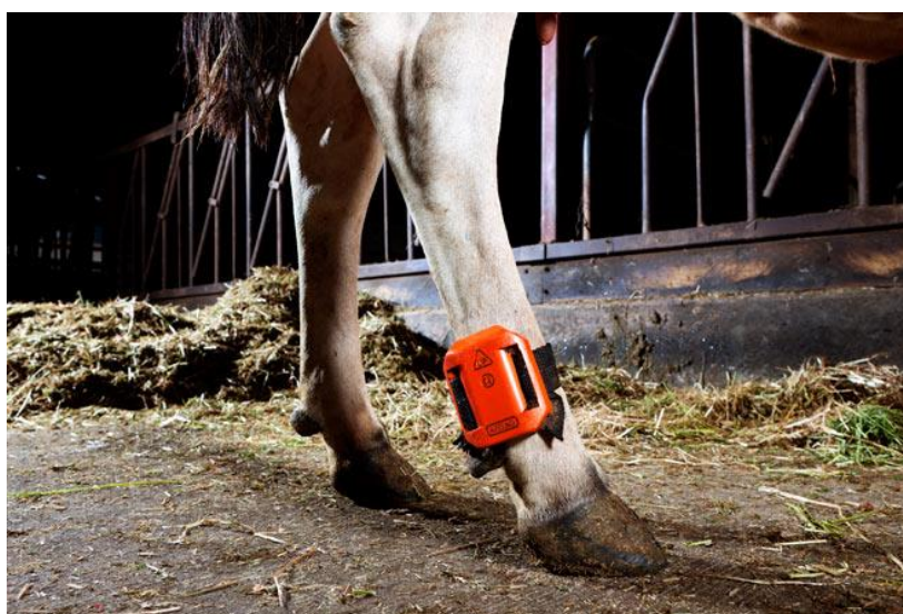
Slika 11. Prikaz postavljenog pedometra na kravi
