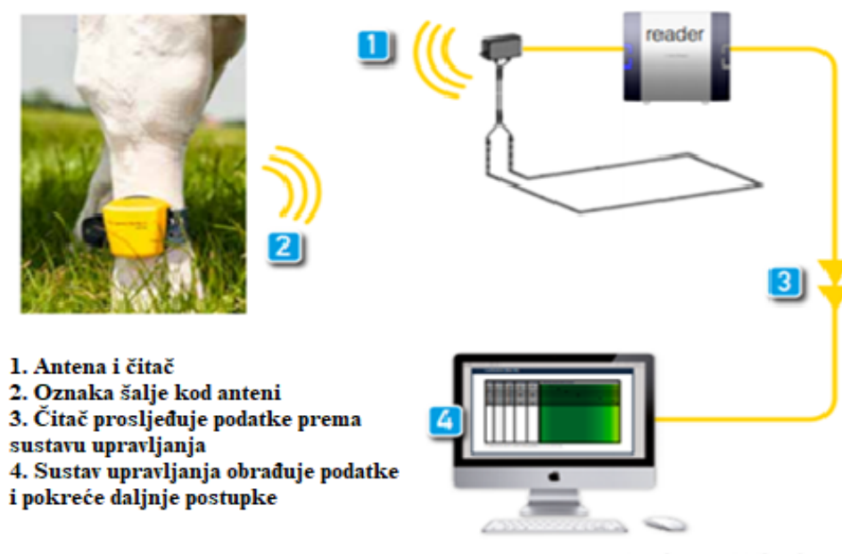
Slika 7. Način rada RFID tehnologija (Nedap, 2017.)
