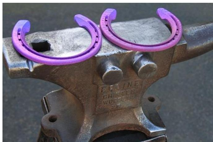
Slika 1. Titanove potkove napravljene po mjeri iz 3D printera
