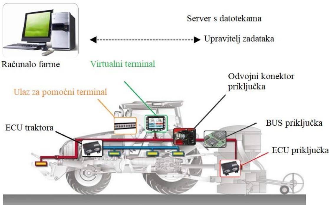
Slika 9. Prikaz sastavnih dijelova ISOBUS – a (Izvor: <http://www.ideagri.net/isobus-standard/what-is-isobus/>)
