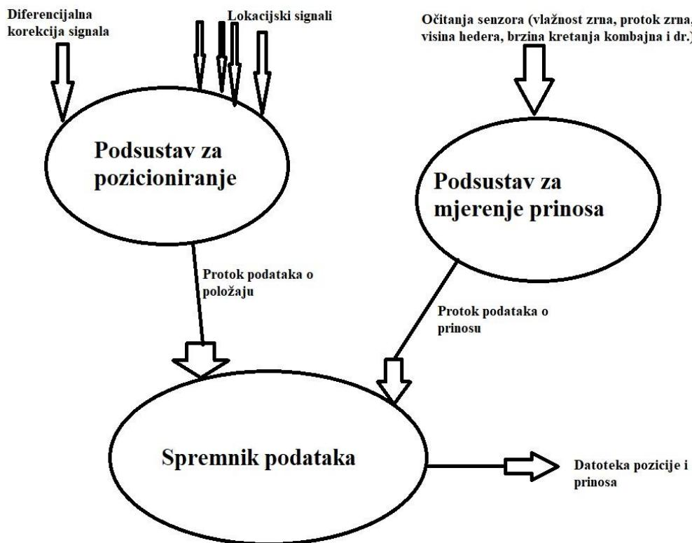
Slika 1. Shema sustava za praćenje prinosa (Izvor: vlastiti)
