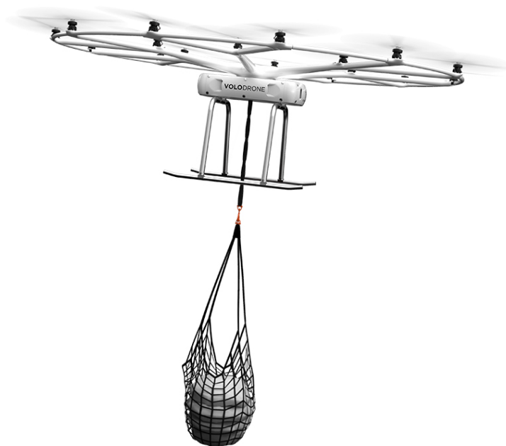
Slika 15. VoloDrone za prijevoz manjeg tereta ( https://www.volocopter.com/solutions/volodrone/ )
