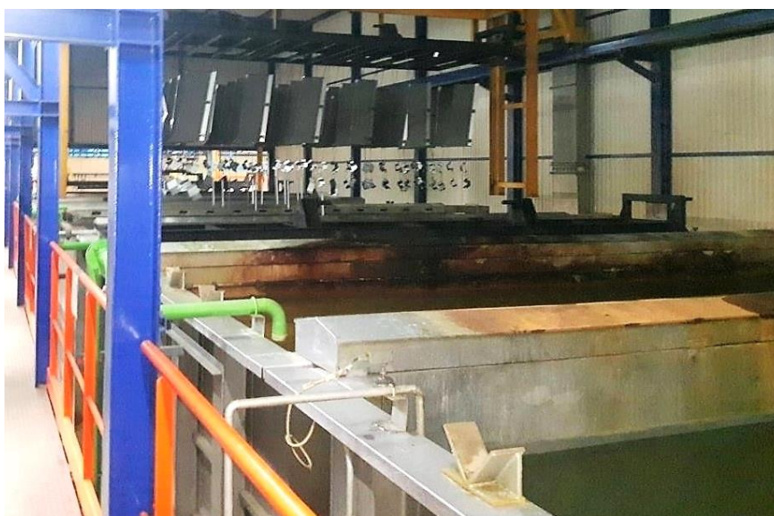
Slika 17. Linija za postupak kataforeze (Izvor: Dugonjić, 2021.)
