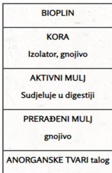
Slika 17. Raspored slojeva u fermentoru
