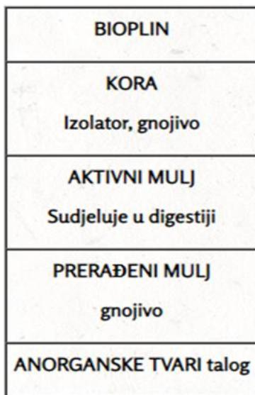
Slika 17. Raspored slojeva u fermentoru
