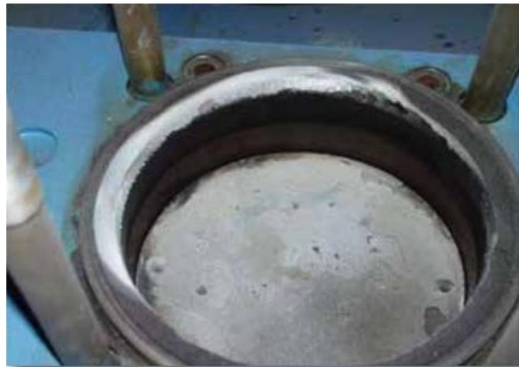
Slika 26. Naslage silicija na klipno – cilindarskom sklopu
