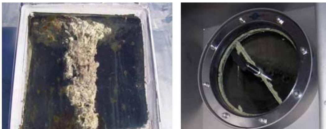
Slika 31. Elementarni sumpor, rezultat biološke desumporizacije unutar fermentatora
