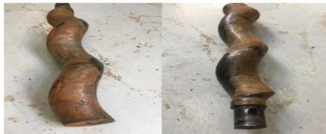
Slika 18. Kavitacijska korozija rotora Biomix crpke
