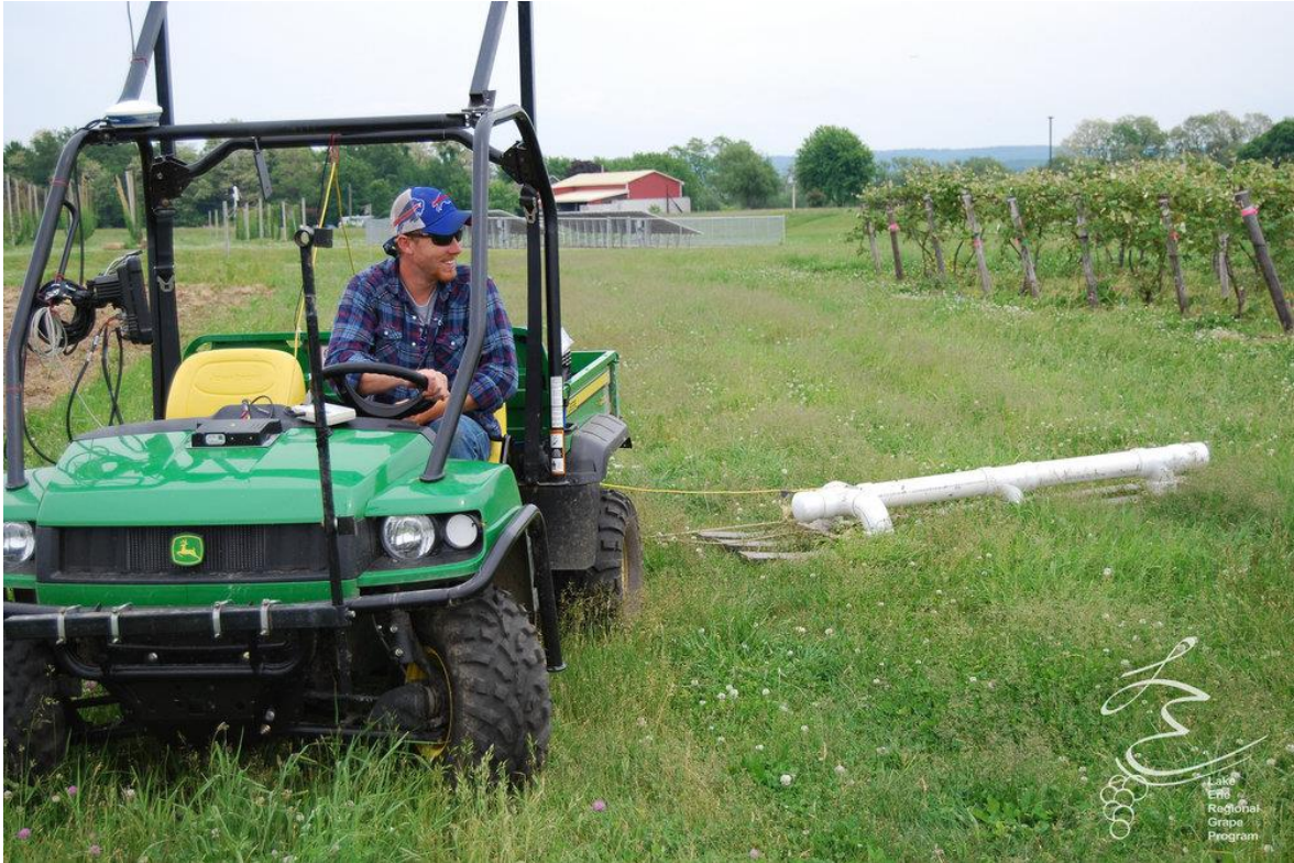
Slika 3. Senzor tla mjeri električnu vodljivost u vinogradu kako bi pružio kartu karakteristika tla (Izvor: https://www.evineyardapp.com/ )
