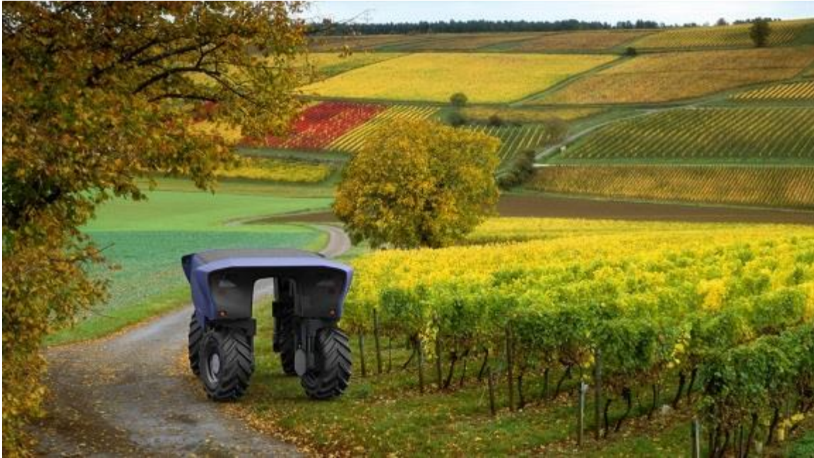
Slika 6. Prikaz robota za prorjeđivanje vinove loze (Izvor: https://www.internationalwinechallenge.com/ )
