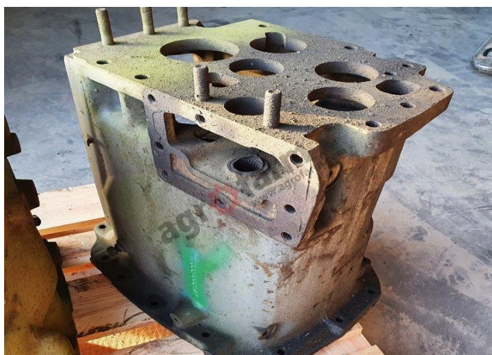
Slika 8. Kućište mjenjača brzina traktora Fendt Farmer 300 (Izvor: https://autoline.info/-/sale/gearbox-housings/tractor/--21080816534759703200 )
