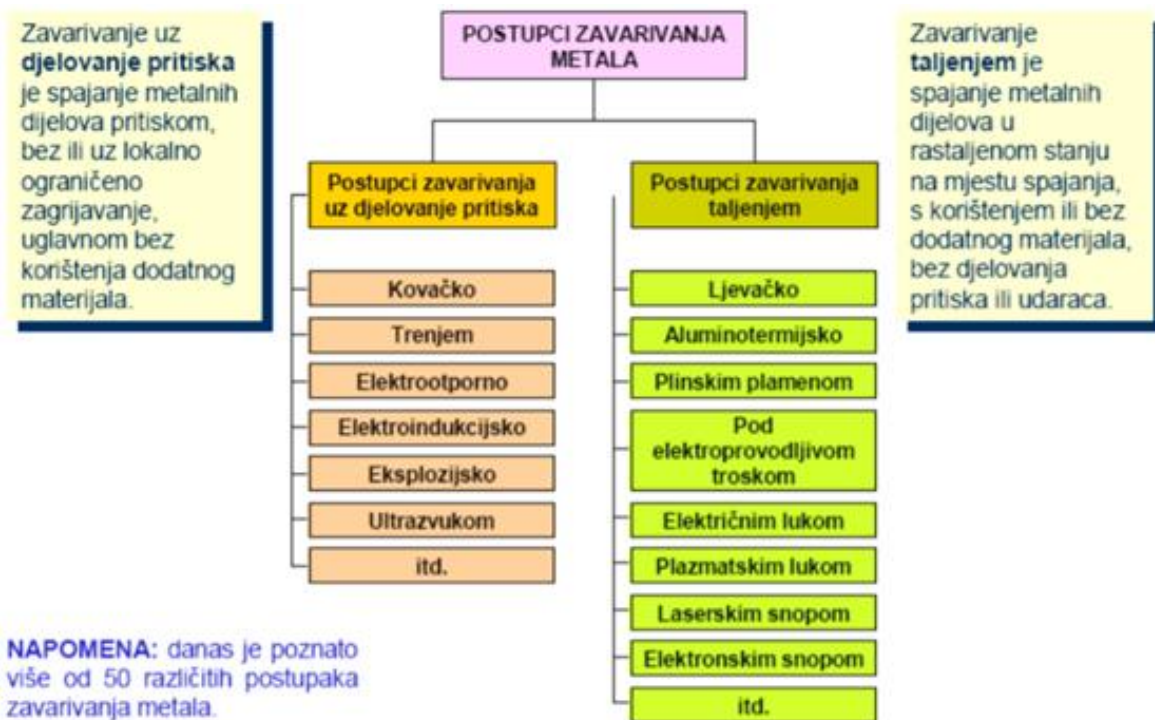
Slika 13: Postupci zavarivanja metala (Izvor: Jeftinija, 2007.)
