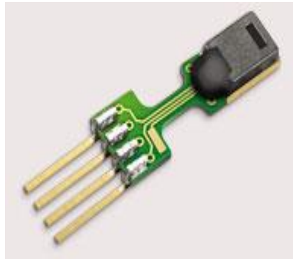
Slika 7. Sensirion SHT 75 senzor, Švicarske proizvodnje.
