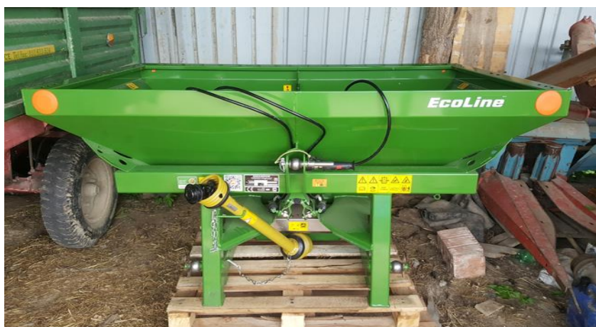
Slika 20. Rasipač ZA-X 900 korišten u prihrani (Izvor: Pipek, M.)
