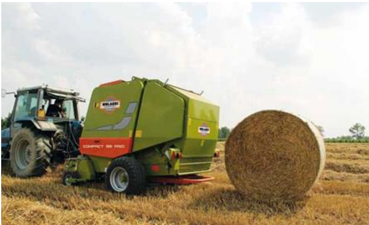
Slika 7. Prikaz stroja za izradu rolo bala slame i sjena
