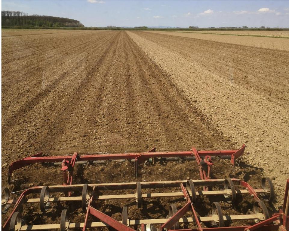
Slika 6. Predsjetvena priprema tla sjetvospremač IMT
