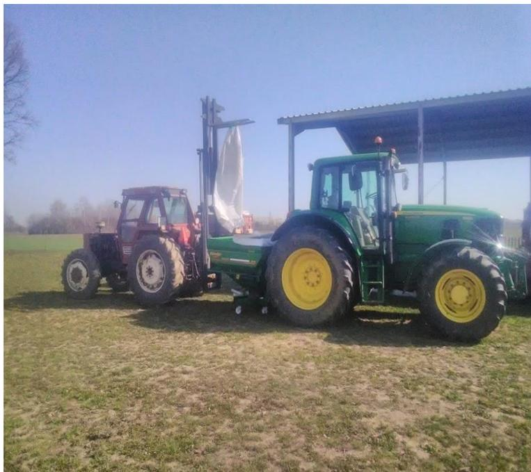
Slika 5. Traktor Fiat agregatiran viličarom i traktor John Deere agregatiran rasipačem Donder 1500 l u prihrani pšenice
