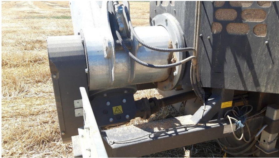
Slika 38. Zupčani prijenos i priključno vratilo na prikolici Fliegl Gigant ASW 271
