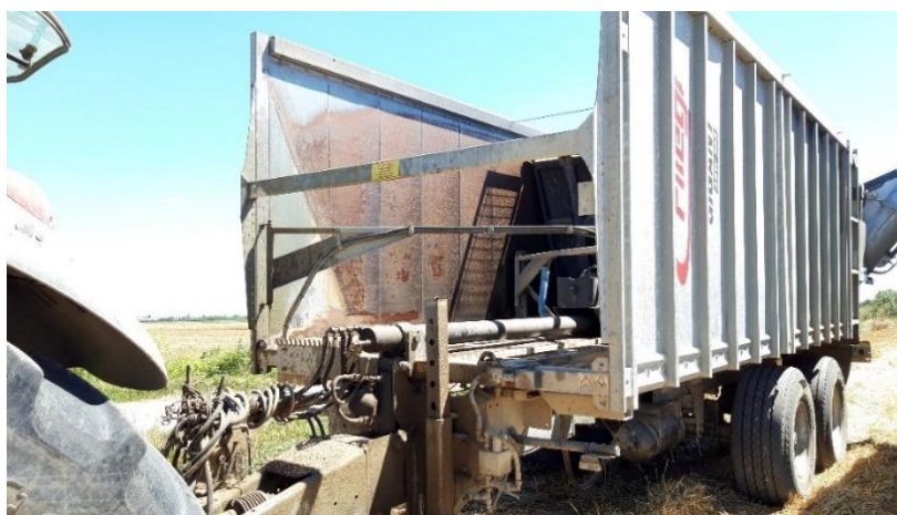
Slika 37. Prednja stranica prikolice Fliegl Gigant AWS 271 potisnuta pomoću hidrauličkog sustava
