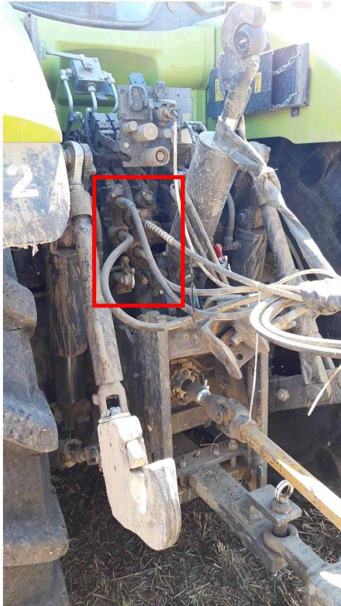
Slika 34. Pneumatske instalacije na traktoru Claas Axion 960
