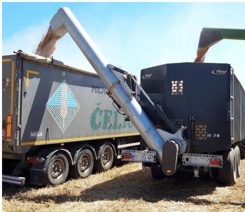
Slika 39. Radni položaj pužnog transportera na prikolici Fliegl Gigant ASW 271
