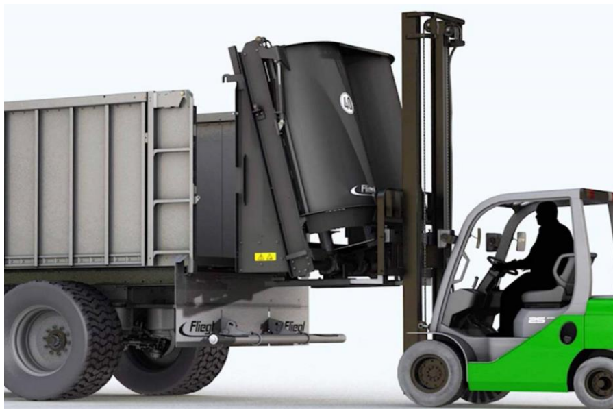
Slika 30. Zamjena zadnje stranice pomoću malog viličara
