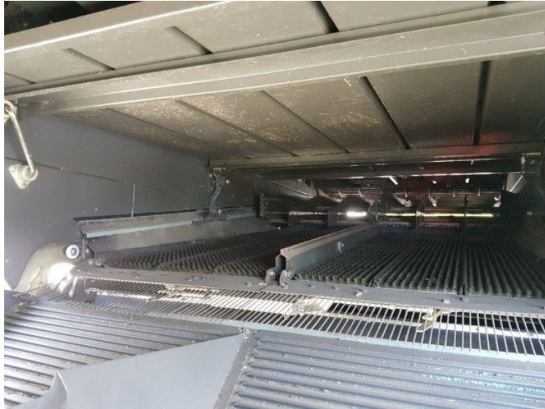
Slika 11. Gornje rešetko kombajna Claas Lexion 560
