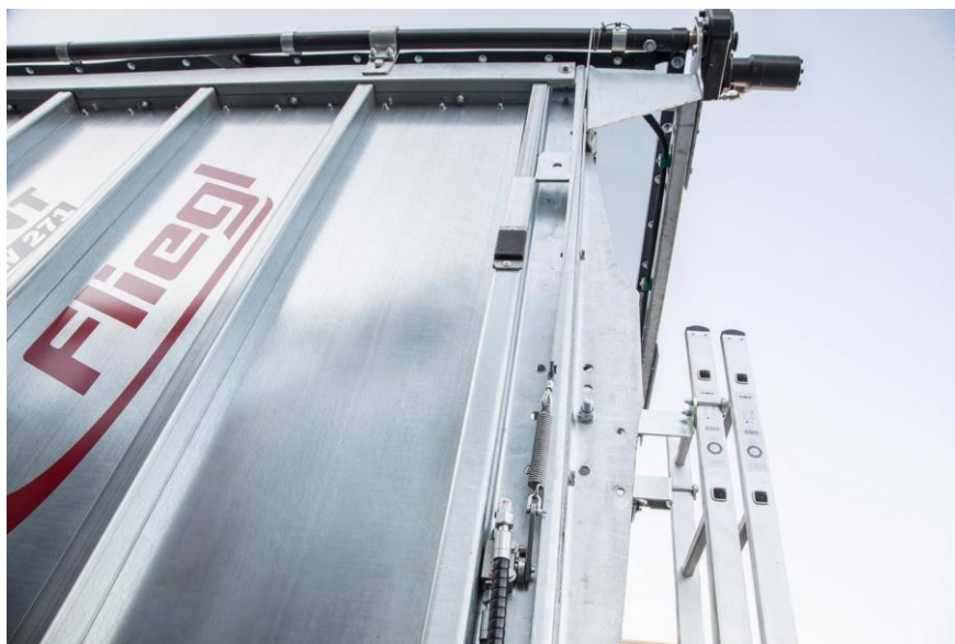
Slika 31. Stranica izrađena od pocinčanog lima
