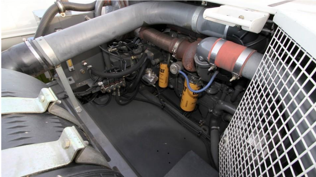
Slika 17. Motor CAT C10 kombajna Claas Lexion 560
