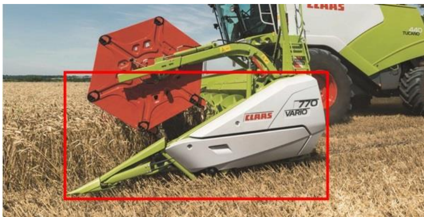
Slika 3. Europska izvedba razdjeljivača na hederu Claas Vario 770
