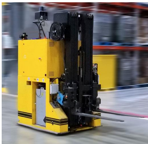
Slika 2. Automatski navođen viličar
