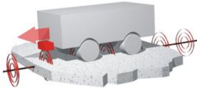
Slika 7. Žični sustav navođenja
