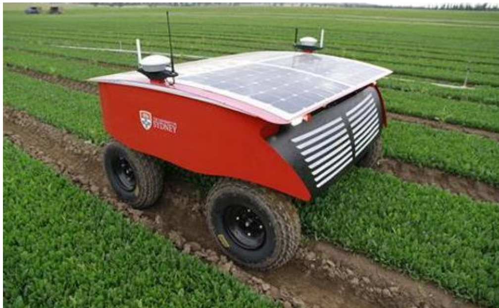
Slika 63. Rippa robot, kemijsko suzbijanje korova (Izvor: https://robot.cfp.co.ir/en/newsdetail/335 )
