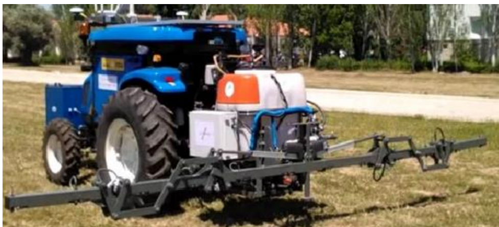
Slika 51. Priključna prskalica sa PLC – om upravljanim mlaznicama
