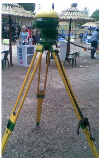
Slika 48. Mobilna RTK stanica
