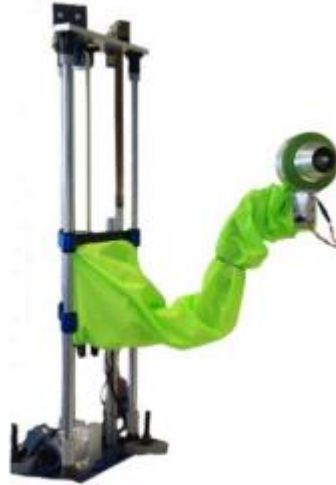
Slika 31. Redundantna robotska ruka sa raspršivačem (Izvor: Bontsema i sur., 2014.)
