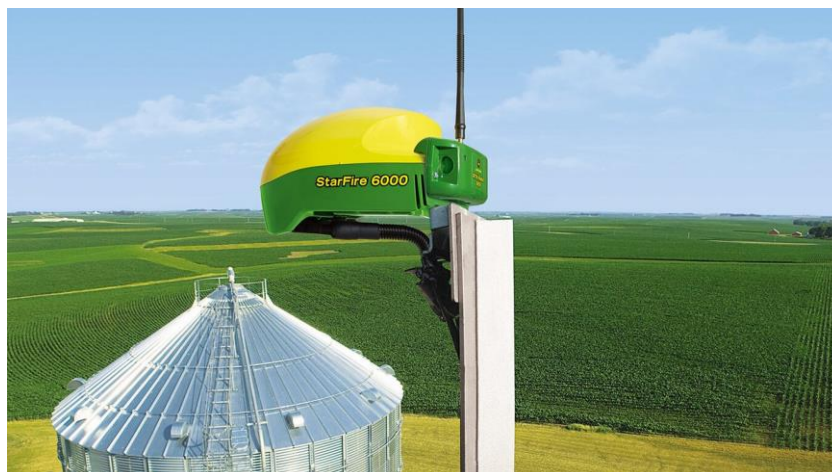
Slika 47. Statička RTK bazna stanica
