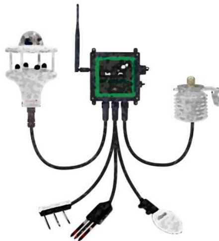
Slika 20. Senzor za kontrolu usjeva
