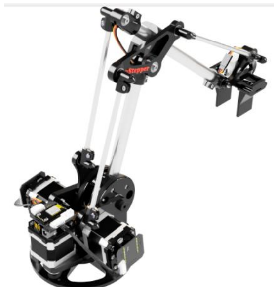
Slika 25. Robotska ruka pogonjena sa koračnim motorima
