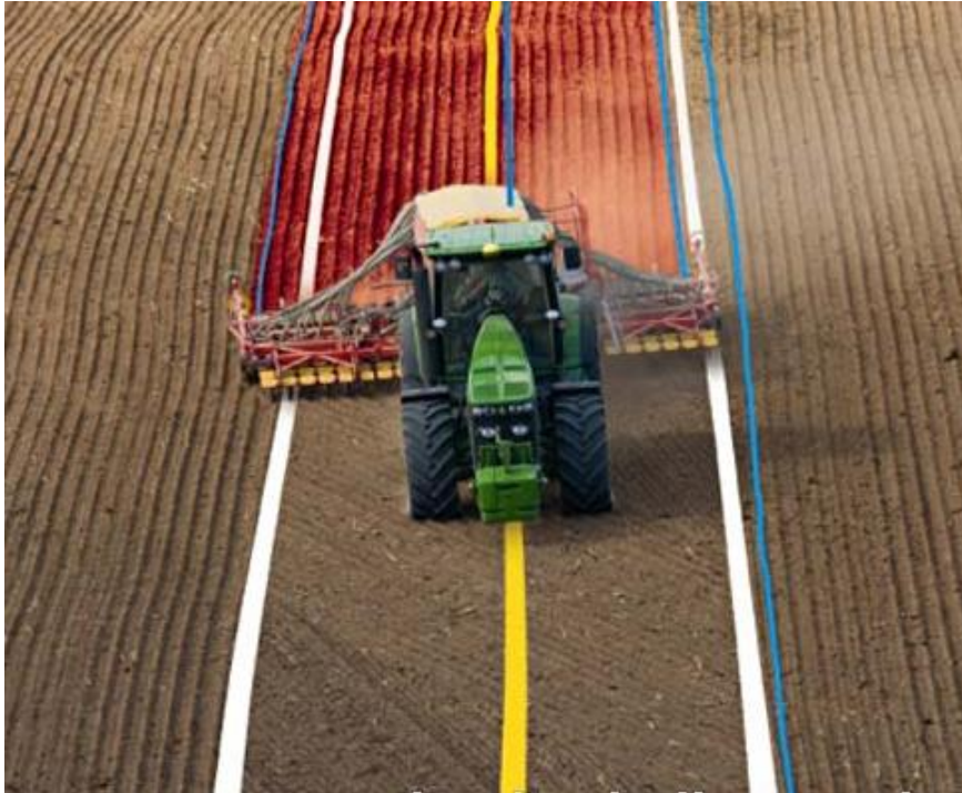
Slika 53. Poravnavanje pravca kretanja traktora i priključka pomoću sustava iGuide i iSteer (Izvor: https://www.landtechnikmagazin.de/sonstige-Landtechnik-XLBild-Arbeiten-ohne-iGuide-fuer-John-Deere-Lenksystem-AutoTrac-am-Seitenhang-9303-1031.php )
