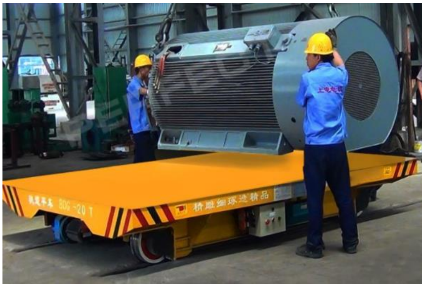
Slika 22. Transportna platforma sa kotačima
