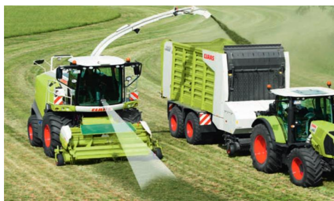
Slika 40. CAM PILOT Claas 3D sustav kamera
