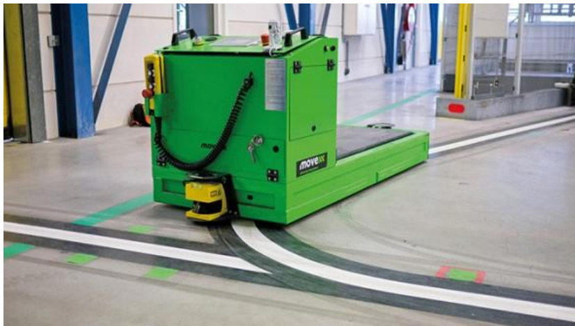
Slika 8. Magnetna traka za navođenje
