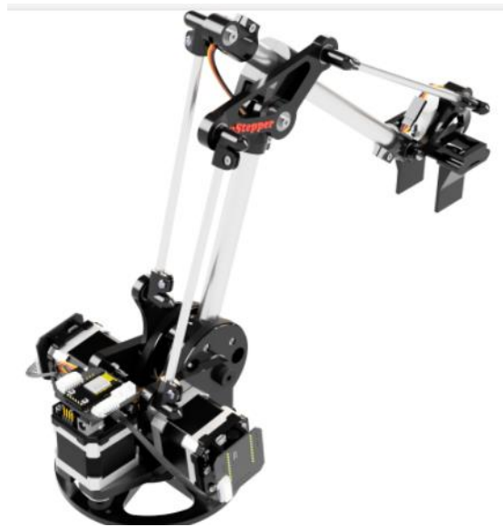
Slika 25. Robotska ruka pogonjena sa koračnim motorima
