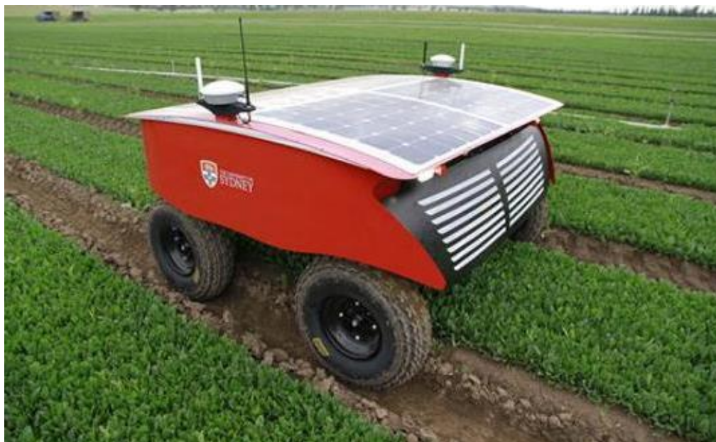
Slika 63. Rippa robot, kemijsko suzbijanje korova (Izvor: https://robot.cfp.co.ir/en/newsdetail/335 )
