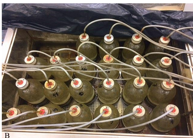
Slika 39. Reaktorske boce u termostatiranoj vodenoj kupelji (Izvor: vlastita fotografija, 2018.)
