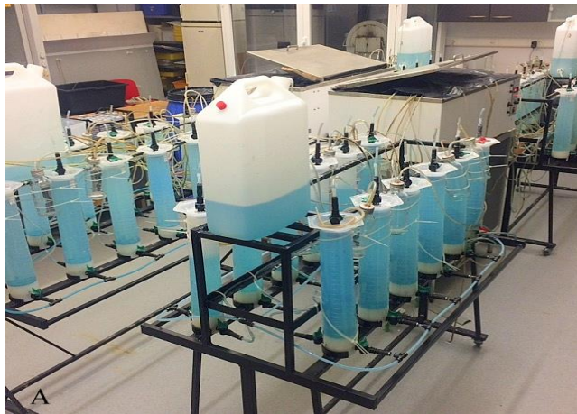
Slika 38. Aparatura za provedbu anaerobne digestije (Izvor: vlastita fotografija, 2018.)
