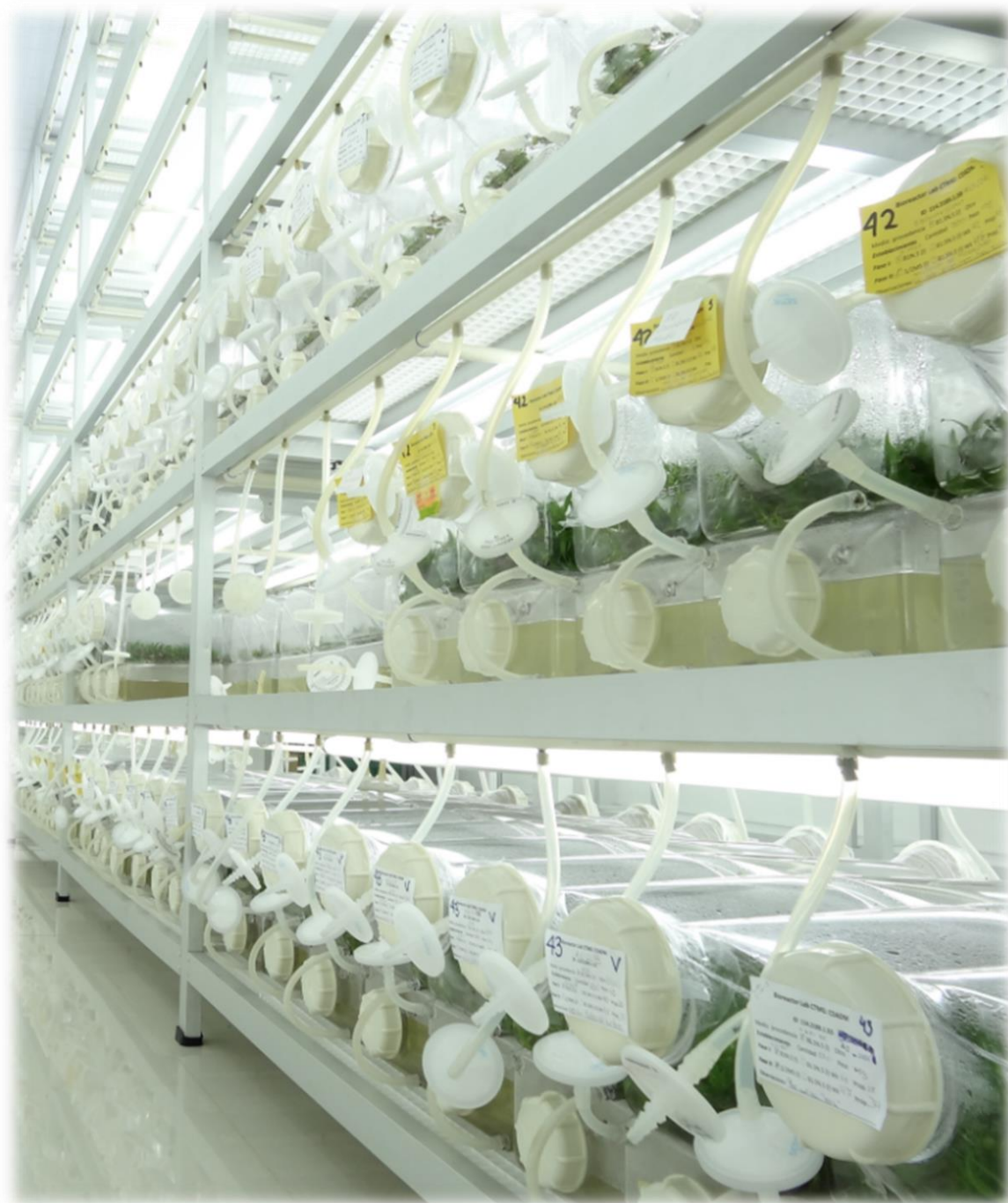
Slika 9. TIB sustav bioreaktora SETIS (Izvor: https://setis-systems.be )
