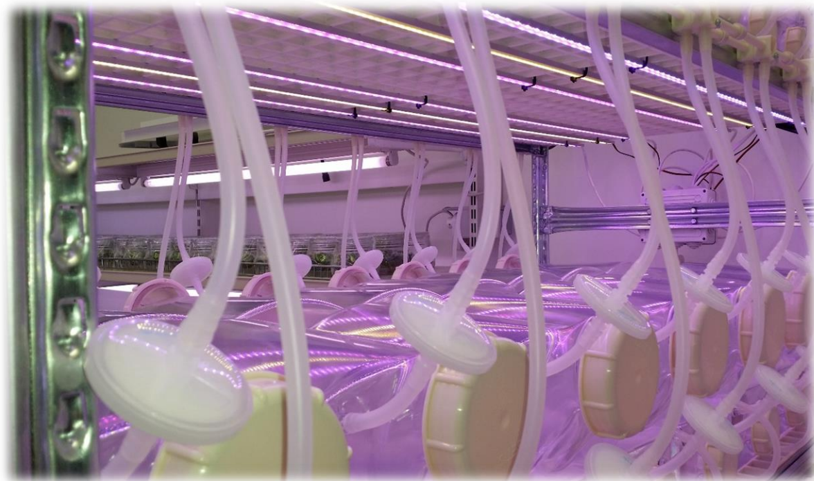
Slika 10. Imerzni sustav bioreaktora SETIS, FAZOS (Foto: Bošnjak, 2020.)
