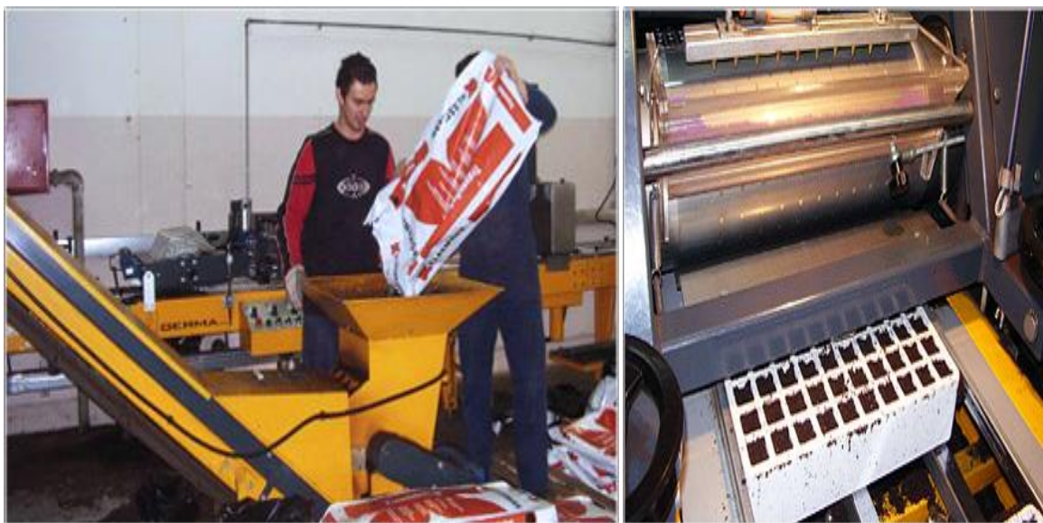
Slika 20. Automatska linija za sjetvu piliranog sjemena
