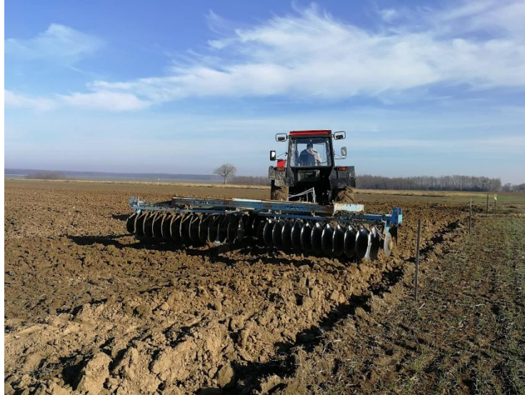
Slika 5. Tanjuranje teškom tanjuračom (Izvor: vlastita fotografija)
