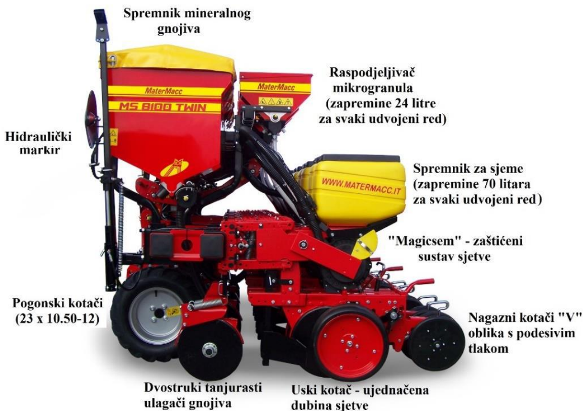
Slika 10. Dijelovi sijačice MaterMacc Twin Row-2
