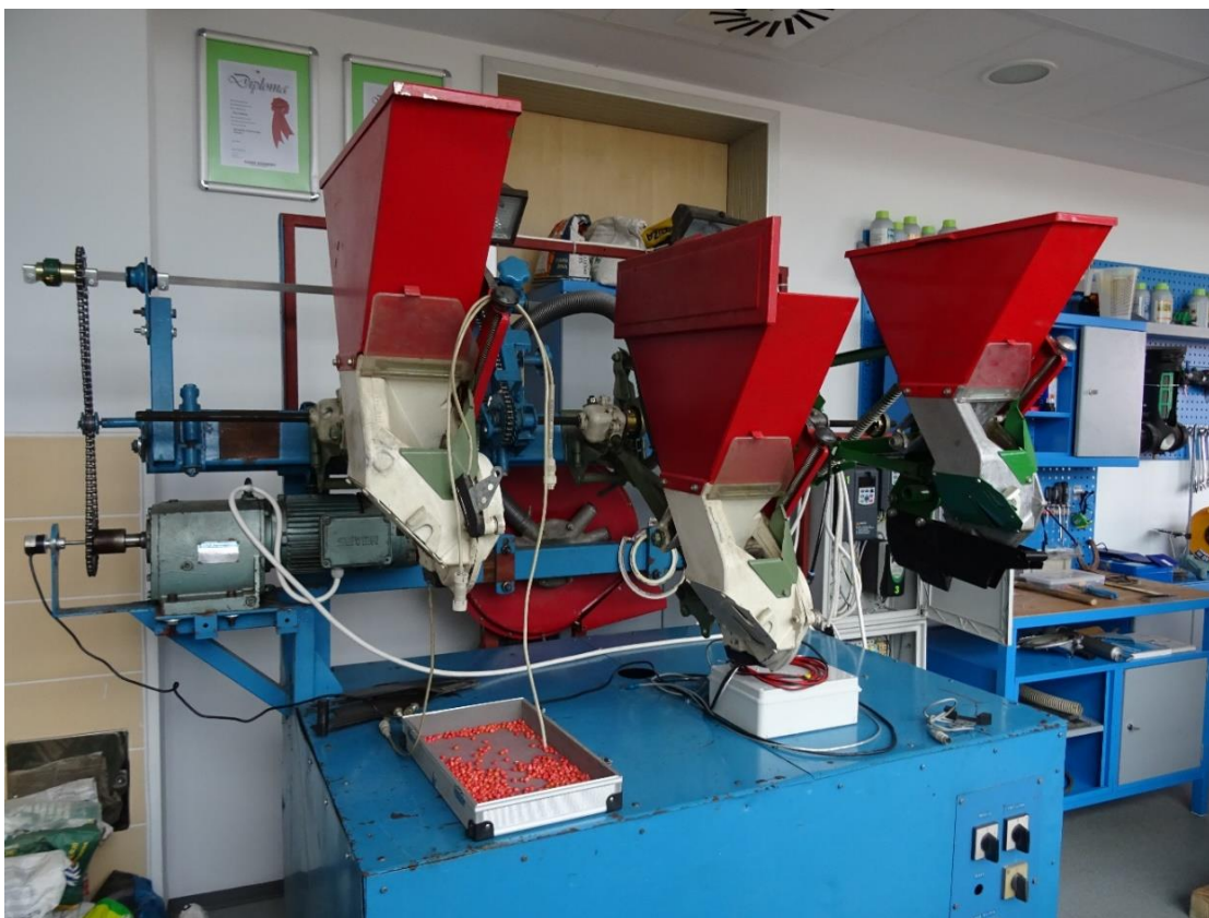
Slika 15. Korišteni ispitni stol za pneumatske sijačice (Izvor: Bunardžija I. V.)
