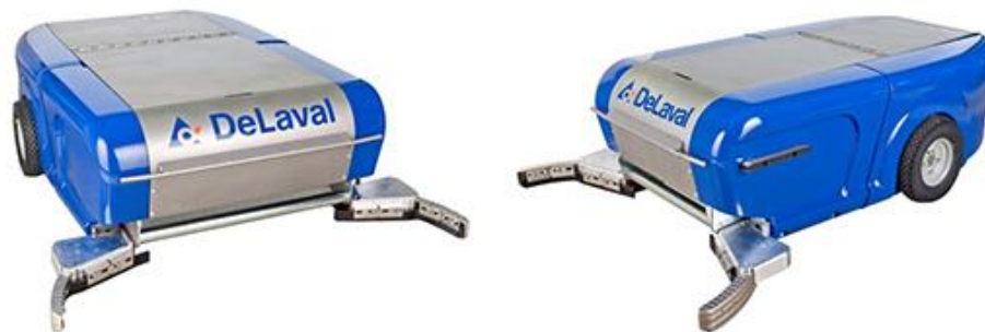
Slika 8. Robot za čišćenje blatnog hodnika firme DeLaval
