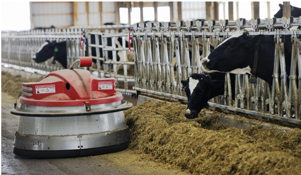
Slika 6. Robot za pregrtanje hrane na hranidbenom stolu firme Lely (tkz. Batler)
