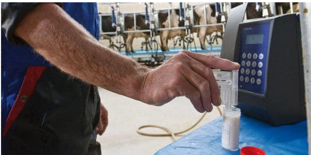
Slika 13. DeLaval brojač somatskih stanica
