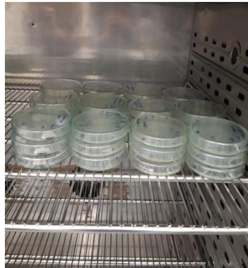
Slika 6. Postavljanje Petrijevih zdjelica u termostat komoru
