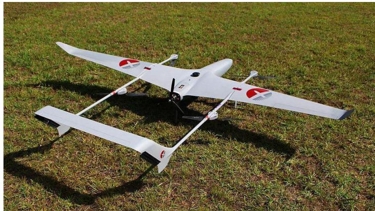
Slika 7. Hibridni bespilotni zrakoplov
