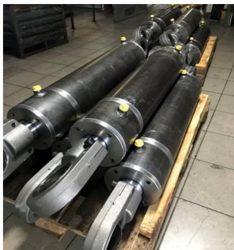
Slika 27. Hidraulički cilindar 180x90 – radni hod 900 mm
