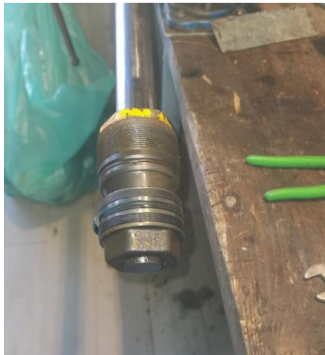
Slika 34. Potrošena klipna brtva
