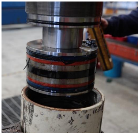
Slika 24. Potrošena klipna brtva i klizeći prstenovi (Izvor: https://blog.berendsen.com.au/hydraulic-cylinder-failure-risks )
