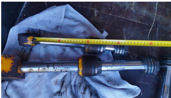
Slika 30. Oštećenje klipnjače (Izvor: Vlastita fotografija)
