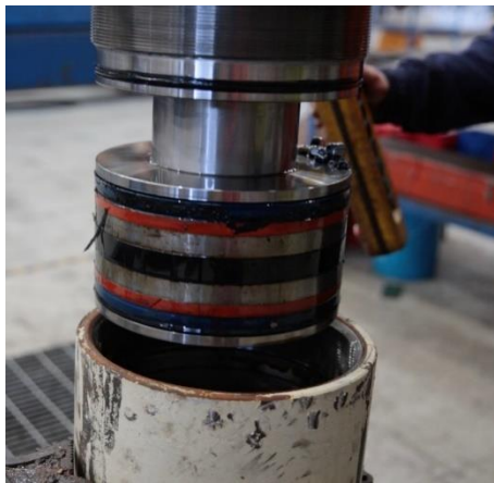
Slika 24. Potrošena klipna brtva i klizeći prstenovi (Izvor: https://blog.berendsen.com.au/hydraulic-cylinder-failure-risks )
