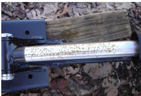
Slika 23. Hidraulički cilindar zahvaćen korozijom
