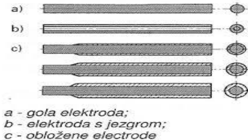
Slika 7. Shema gole elektrode, elektrode s jezgrom i obložene elektrode
