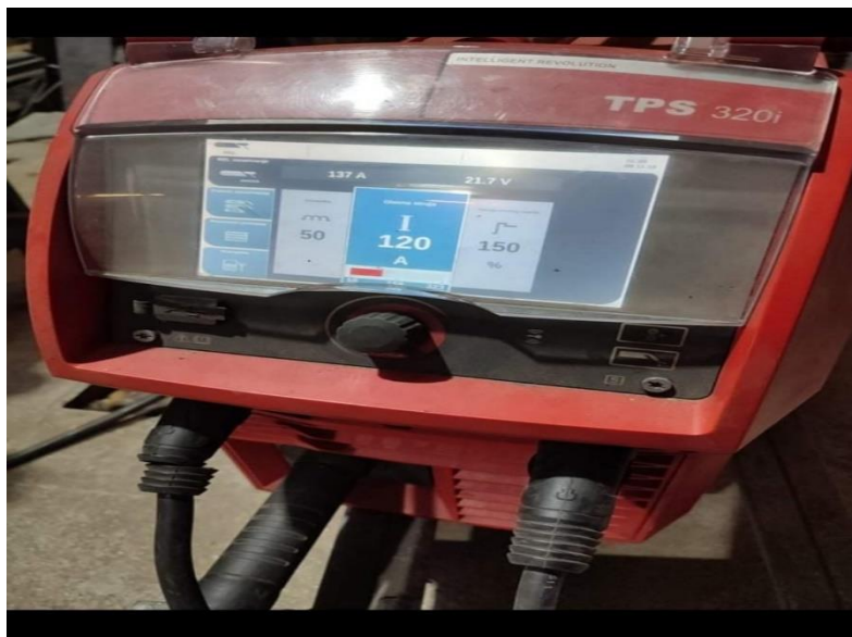
Slika 6. Aparat za zavarivanje „FRONIUS TPS 320i“ koji je korišten u izradi rada
