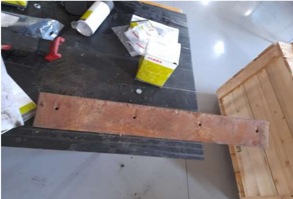
Slika 6. Prikazuje istrošeni čistač kontranoža (Izvor: Vlastita fotografija).
