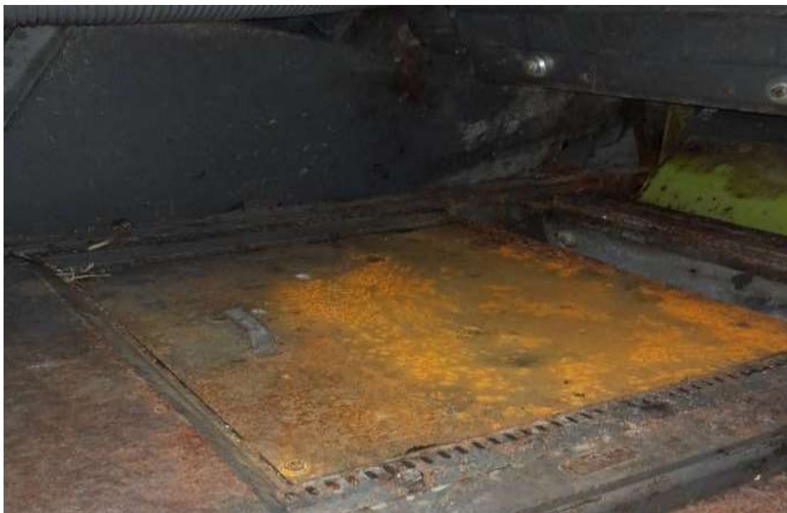
Slika 26. Vidljiv je veliki utjecaj korozije na oplati i zaštitnom limu (Izvor: Vlastita fotografija)
