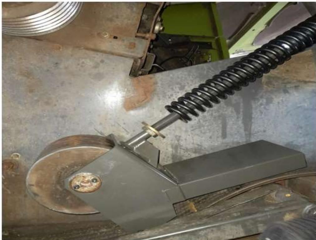
Slika 16. Prikazuje novi zatezač remena i oprugu (Izvor: Vlastita fotografija)
