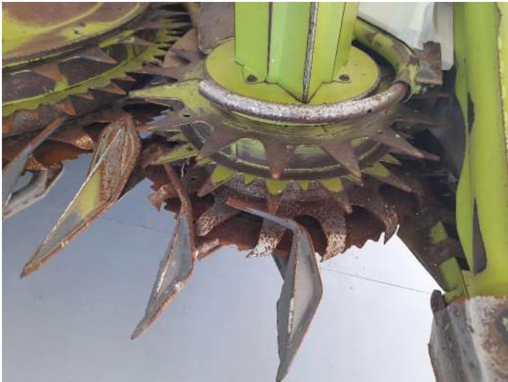
Slika 24. Prikazuje istrošene dijelove hedera (Izvor: Vlastita fotografija)
