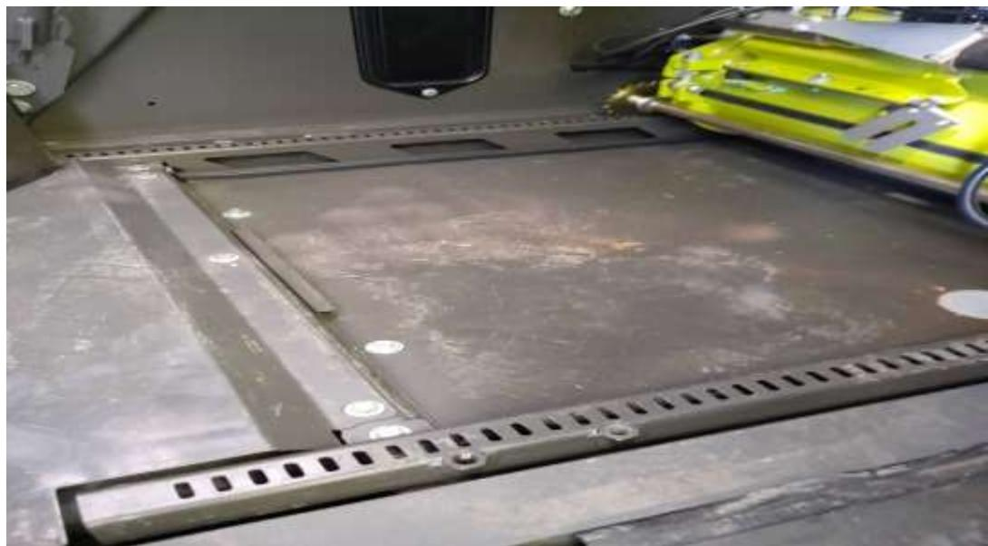
Slika 27. Na slici je vidljiva nova oplata i zaštitni limovi (Izvor: Vlastita fotografija)
