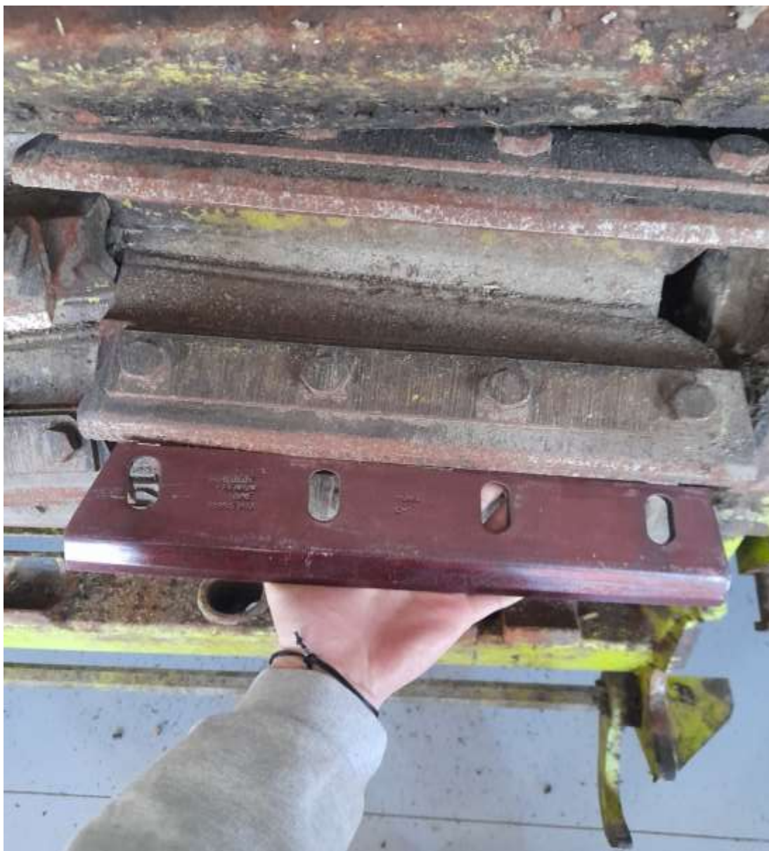
Slika 17. Prikazuje usporedbu istrošenog i novog noža sječke (Izvor: Vlastita fotografija)
