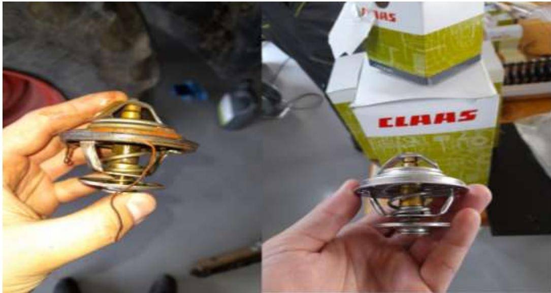
Slika 22. Prikazuje istrošeni termostat (lijevo) i novi termostat (desno) (Izvor: Vlastita fotografija)
