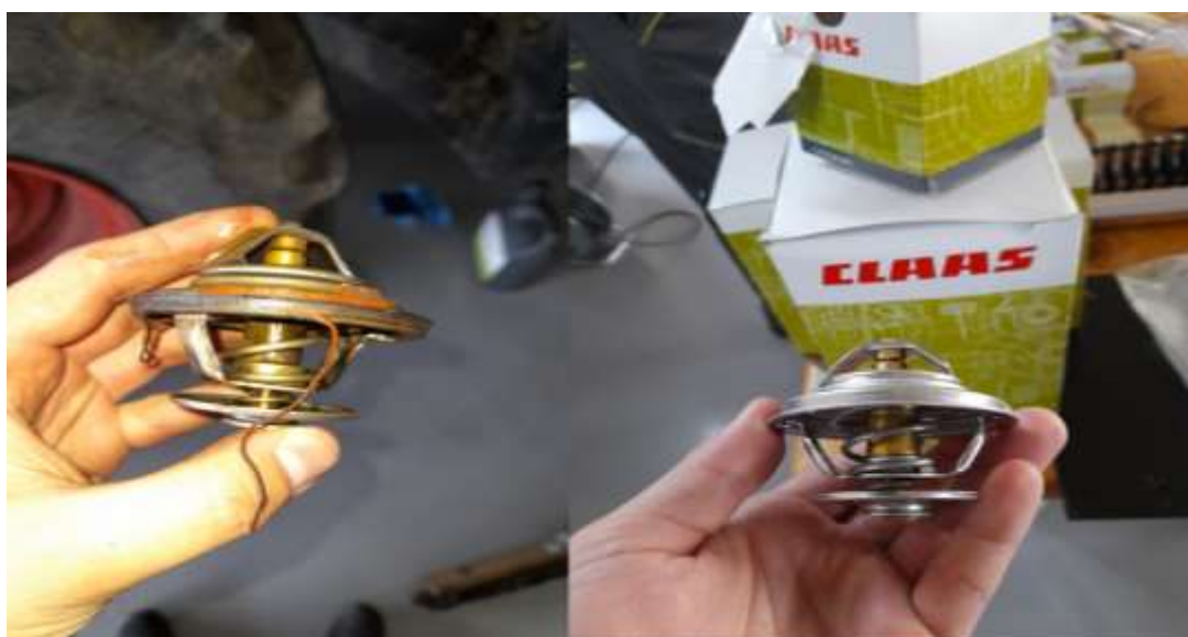
Slika 22. Prikazuje istrošeni termostat (lijevo) i novi termostat (desno) (Izvor: Vlastita fotografija)
