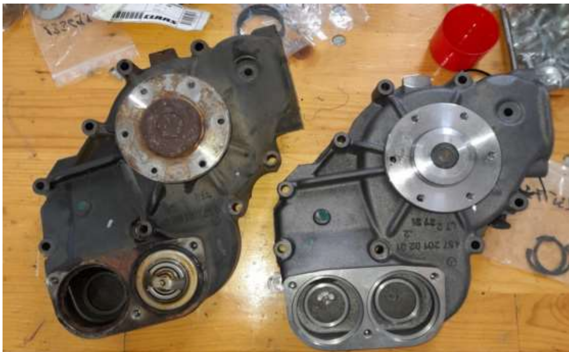
Slika 21. Prikazuje istrošenu vodenu pumpu (lijevo) i novu vodenu pumpu (desno) (Izvor: Vlastita fotografija)
