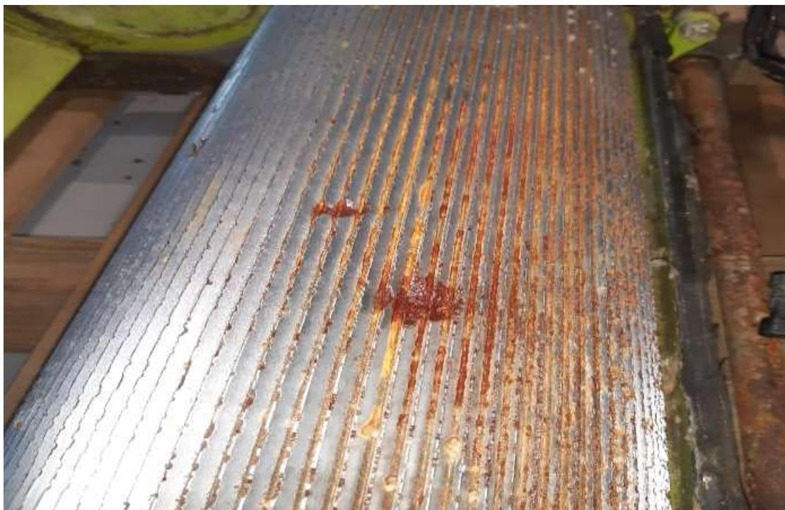
Slika 10. Prikazuje istrošene dijelove *Corn cracker* (Izvor: Vlastita fotografija)
