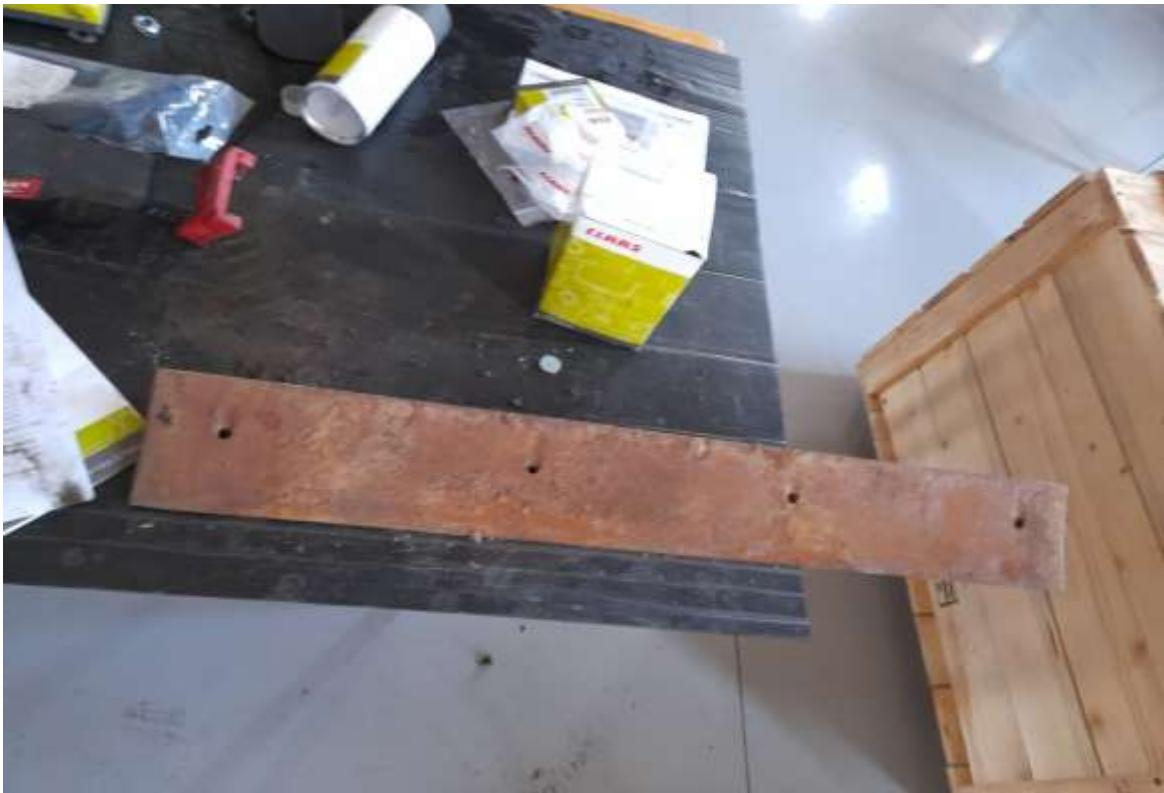
Slika 6. Prikazuje istrošeni čistač kontranoža (Izvor: Vlastita fotografija).
