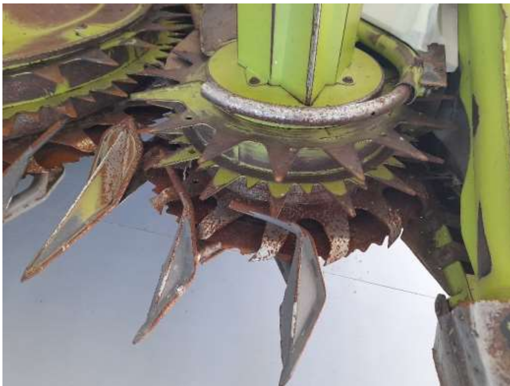
Slika 24. Prikazuje istrošene dijelove hedera (Izvor: Vlastita fotografija)
