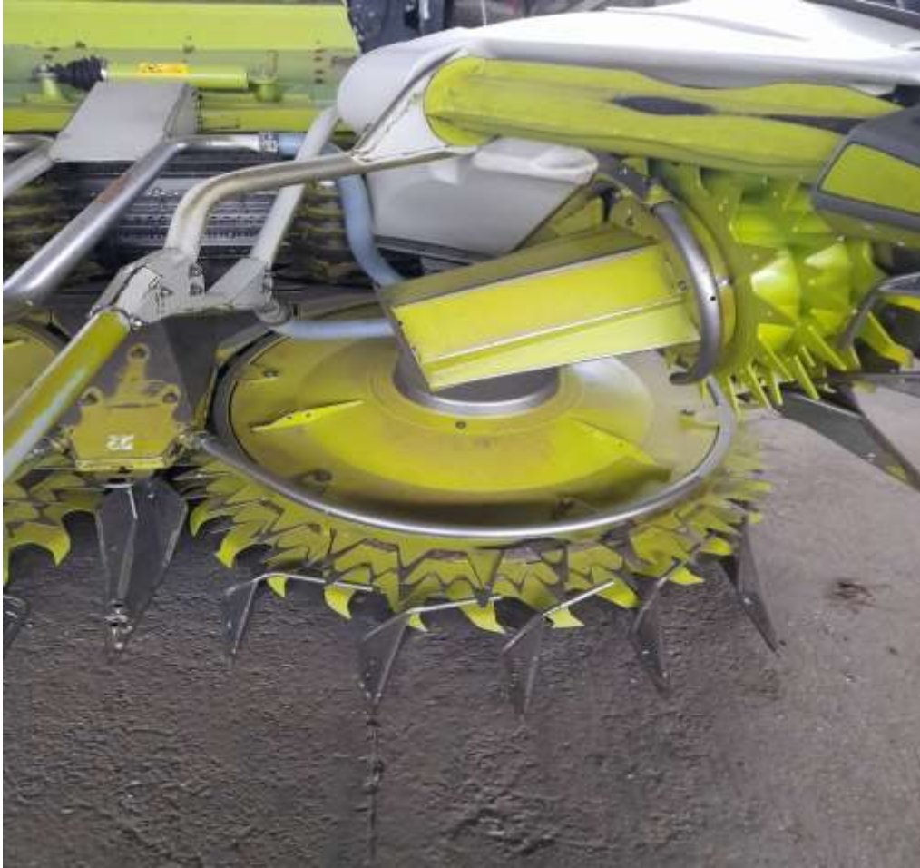
Slika 25. Prikazuje Pravilno očišćen i konzerviran heder (Izvor: Vlastita fotografija)
