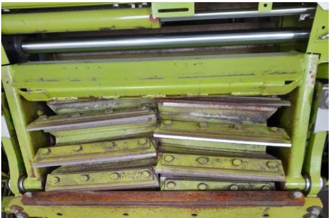
Slika 8. Prikazuje naoštrene noževe sječke (Izvor: Vlastita fotografija)
