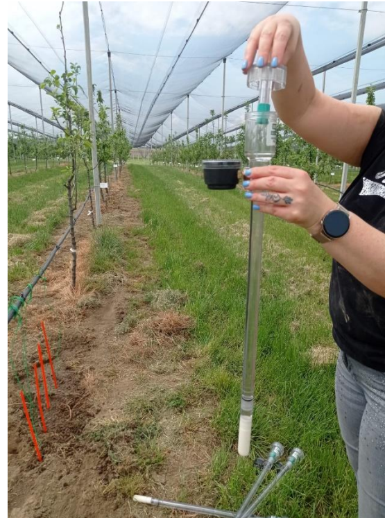
Slika 19. Punjenje senzora destiliranom vodom
