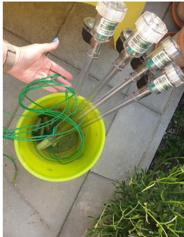
Slika 17. Tenziometri u posudi s vodom
