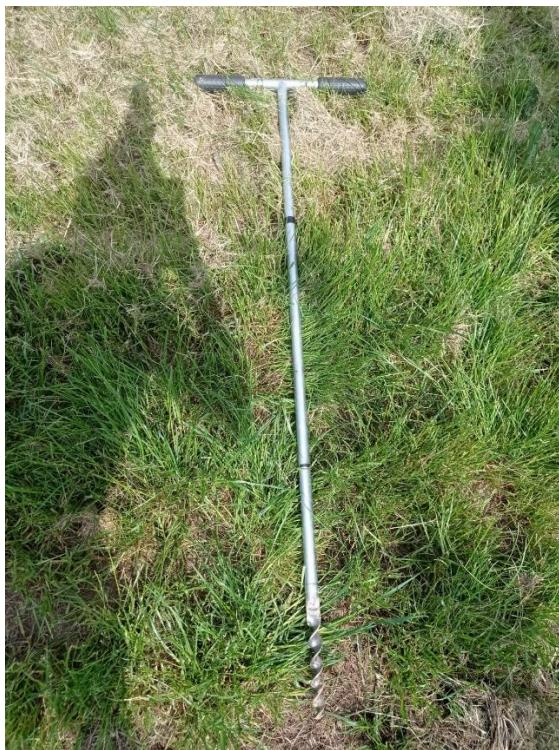
Slika 18. Srvdlo za postavljanje senzora u tlu
