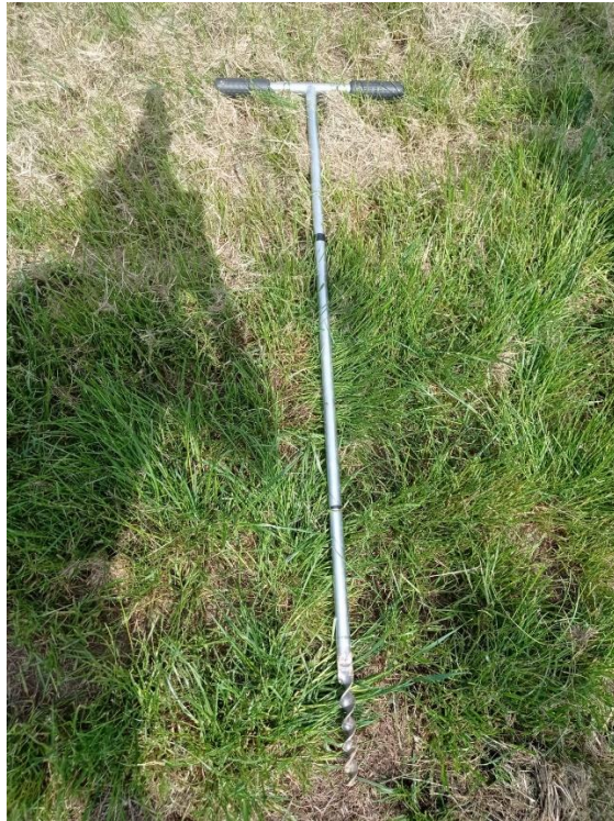
Slika 18. Svrđlo za postavljanje senzora u tlo
