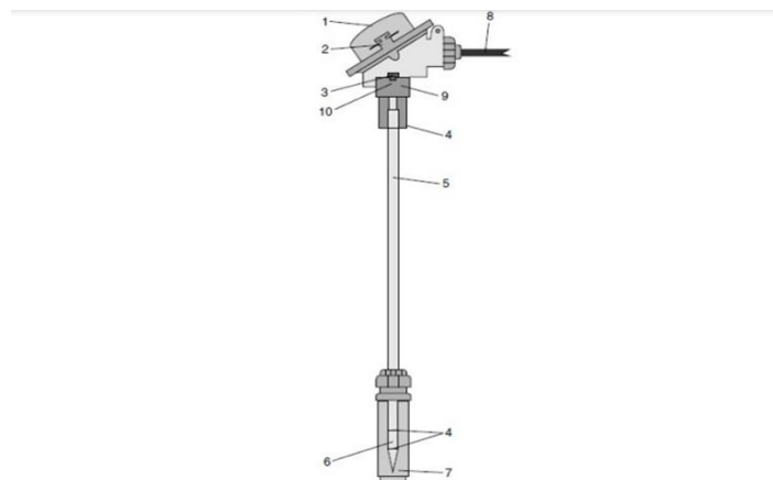
Tenziometar za mjerenje vlage tla. 1 - kućište, 2 - pojačalo signala, 3 - pretvarač pritiska, 4 - brtveni prsten, 5 - okomita cijev, 6 - ćelija tenziometra, 7 – zaštitni pokrov, 8 - ulaz, 9 - transportna brtva, 10 - indikator mjehurića
