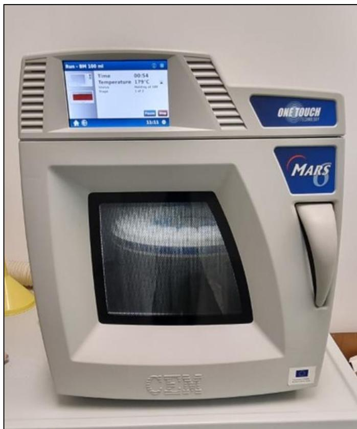
Slika 7. Razaranje uzoraka u mikrovalnoj peći
