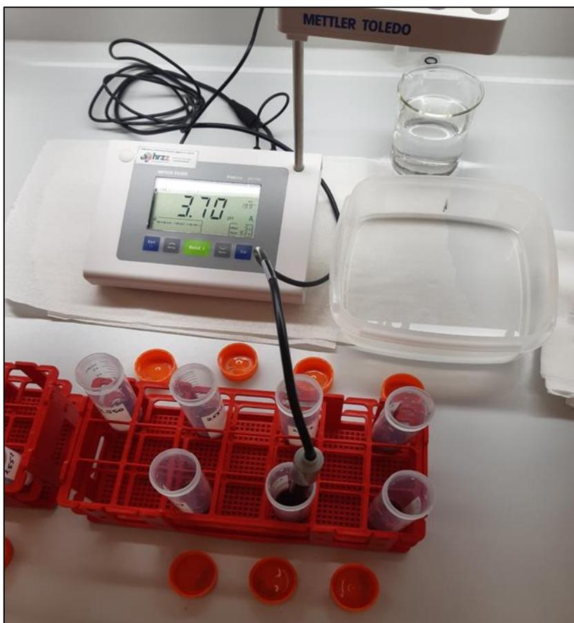
Slika 5. Mjerenje pH vrijednost uzoraka
