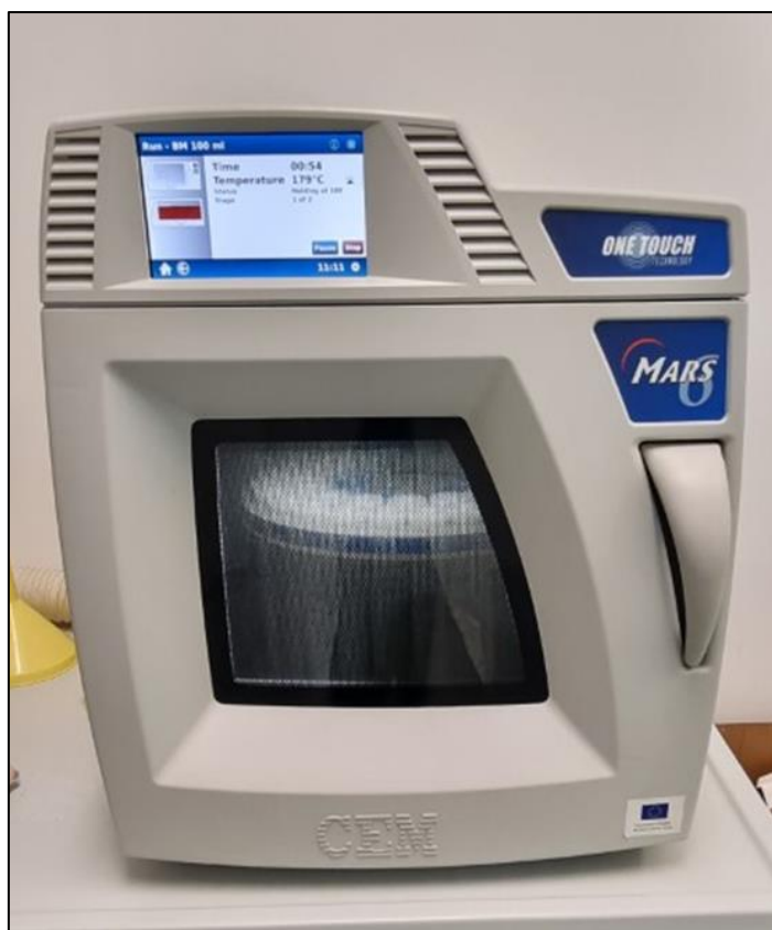
Slika 7. Razaranje uzoraka u mikrovalnoj peći
