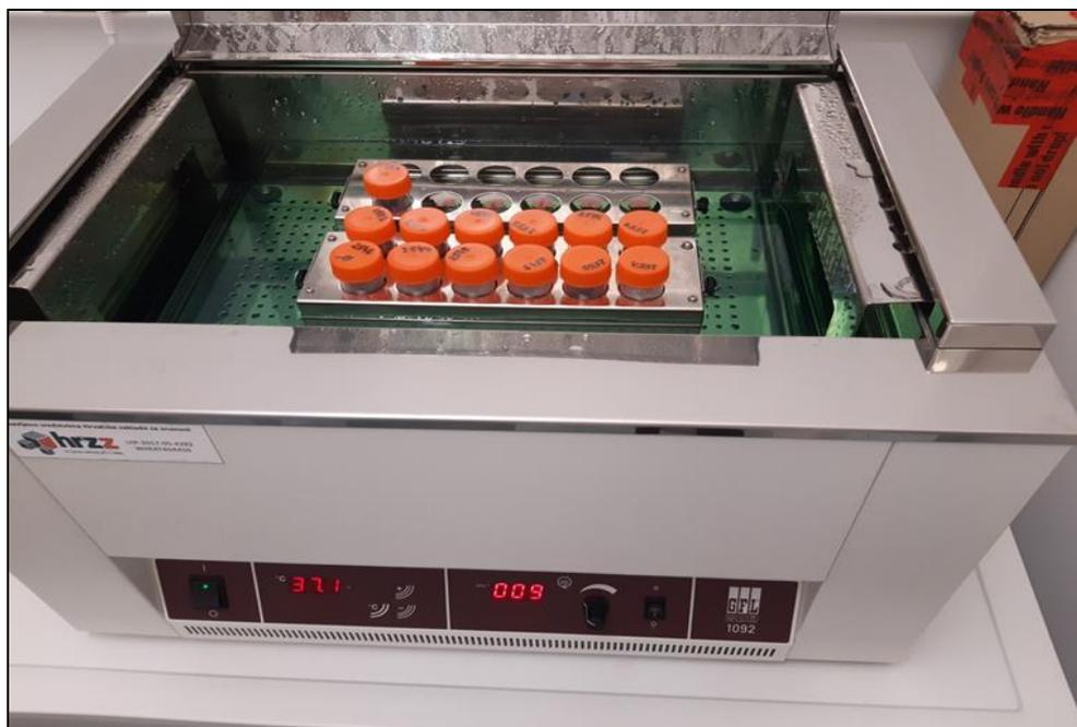
Slika 6. Uzorci u vodenoj kupelji s treskalicom
