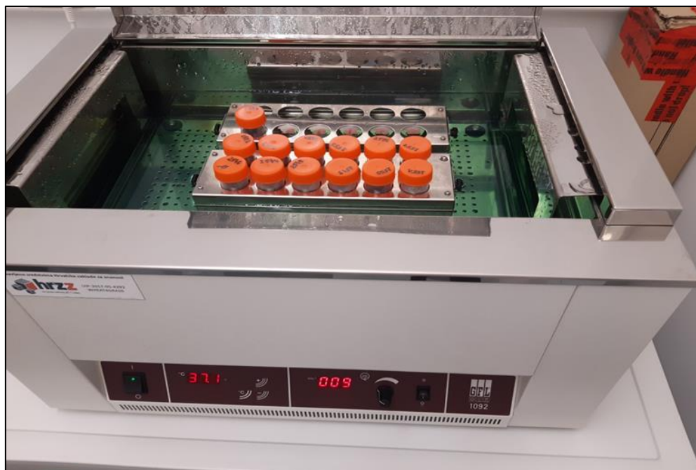
Slika 6. Uzorci u vodenoj kupelji s treskalicom
